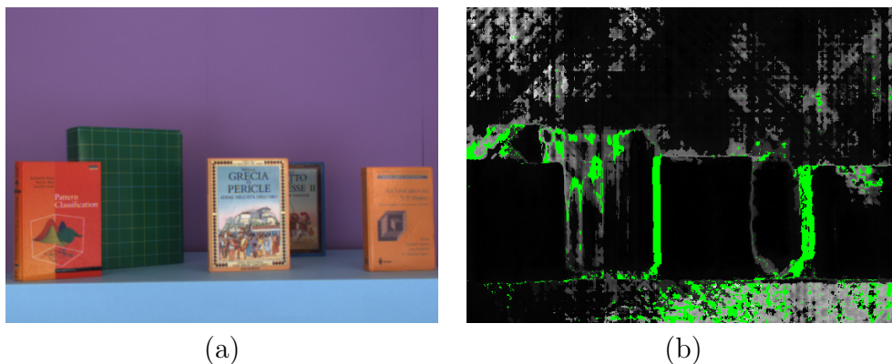
Figura 4.17: Stima dell'errore per l'algoritmo stereo. Dataset 2: (a) immagine della telecamera sinistra; (b) stima dell'errore. I punti verdi indicano punti senza disparità e, quindi, senza stima di errore.
