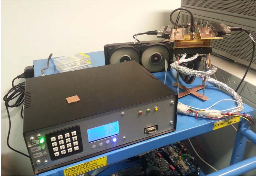
Figura 6.3: Setup di misura realizzato in laboratorio MOSLAB, si distinguono il controllore delle celle peltier, il portacampioni con le connessioni per i terminali dell'OTFT ed il sistema di raffreddamento/riscaldamento.
