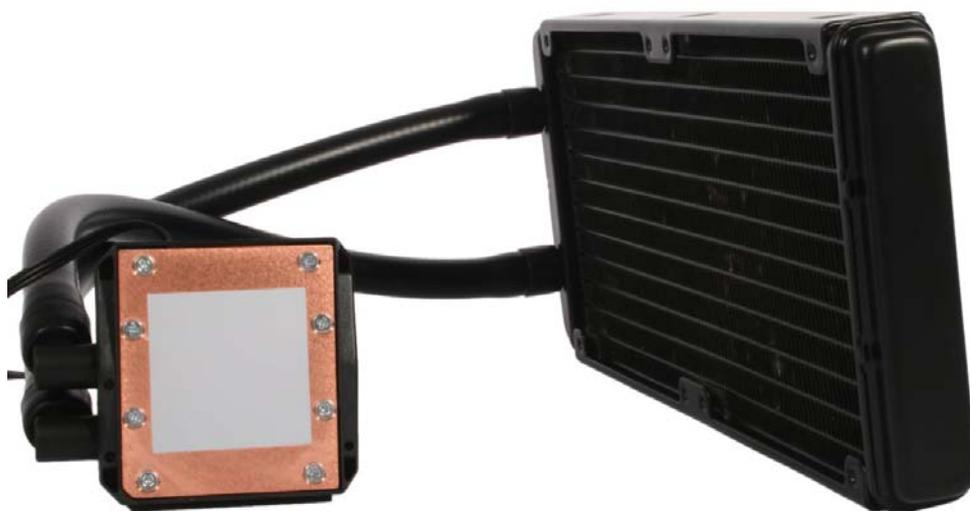
Figura 6.11: Dissipatore per CPU H100i utilizzato nel setup di misura.
