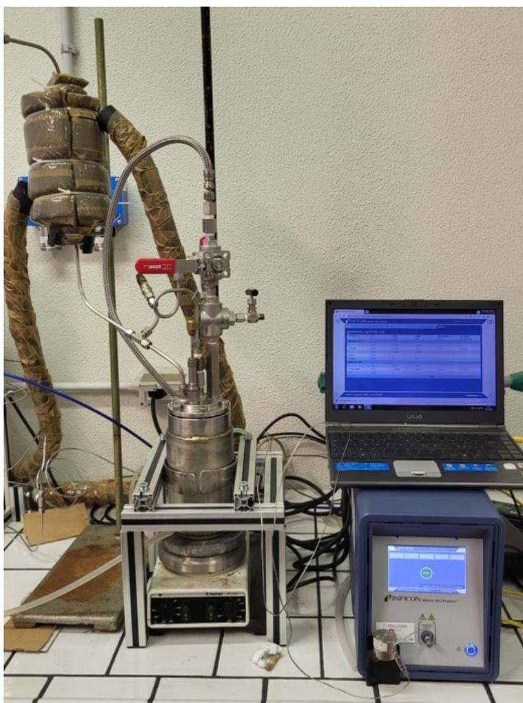
*Figura 31. Set-up strumentale reattore in pressione.*
