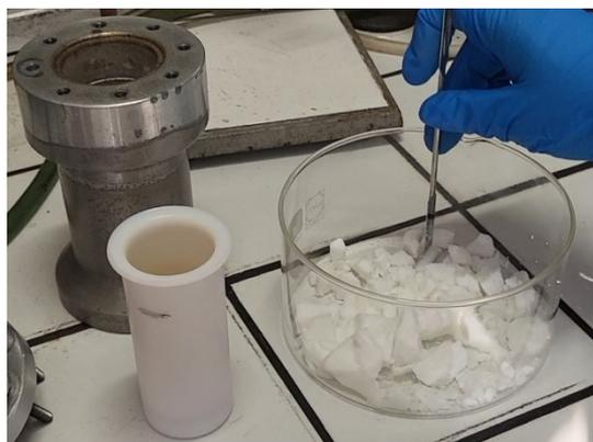
Figura 24. Monolite di pDVB spezzettato.
