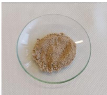
Figura 26. Resina con granulometria compresa tra 180 e 400  $\mu\text{m}$  dopo essiccamento in stufa a 110°C.
