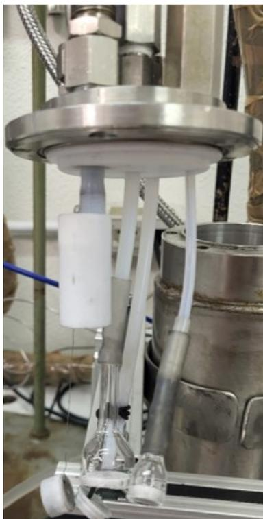
*Figura 32. Testa del reattore in pressione.*
