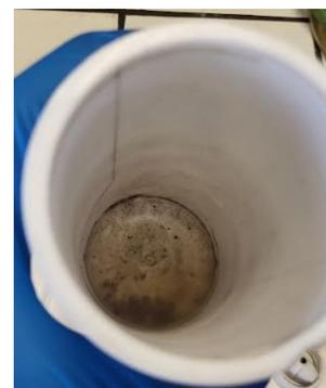
Figura 51. Residui di Pd/pDVB-SO<sub>3</sub>H nel liner alla fine del test catalitico.
