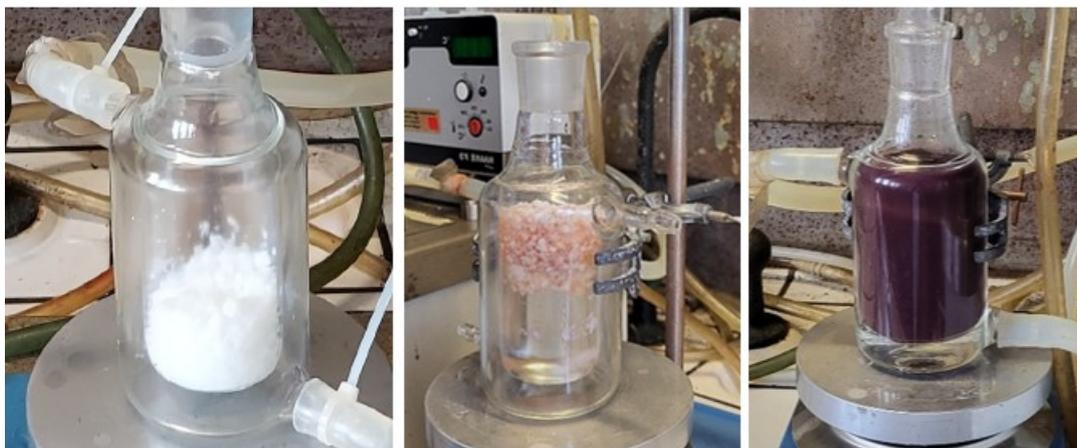
Figura 25. Resina rigonfiata con DCE (a sinistra), dopo l'aggiunta di  $H_2SO_4$  (al centro) e durante la solfonazione (a destra).
