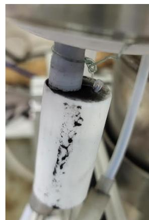
*Figura 70. Frazione del catalizzatore trasferita sulla superficie superiore dell'apposito contenitore.*
