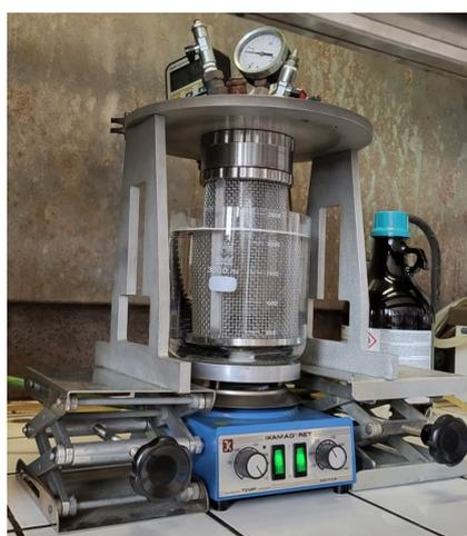
Figura 27. Autoclave durante la riduzione del Pd(II) sul supporto polimerico.
