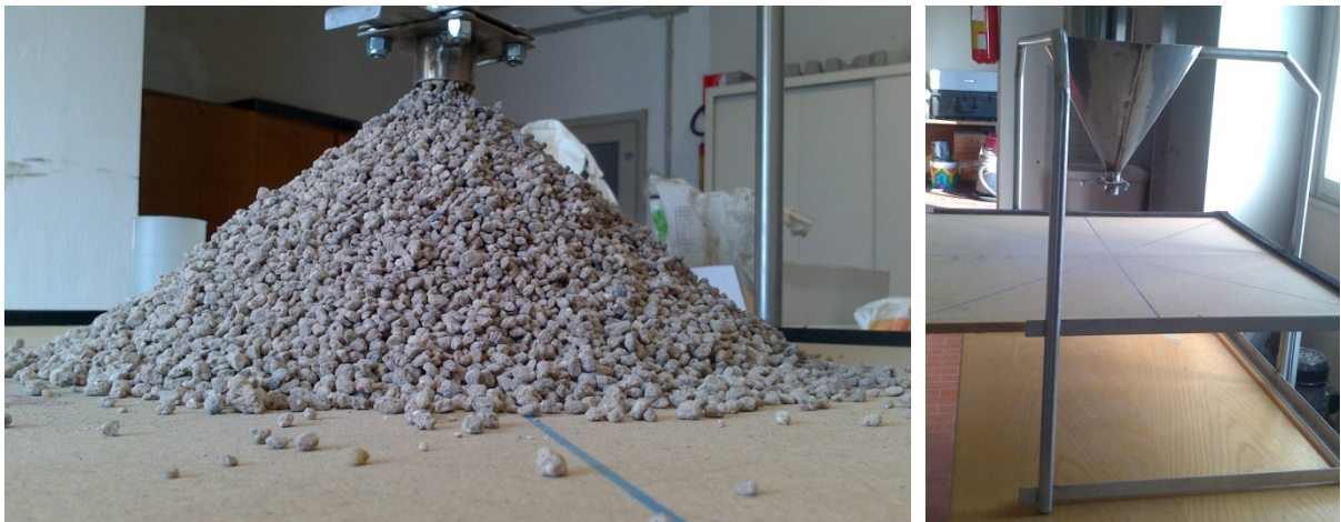
Figura 3.2. Concime nella tipica distribuzione conica (a sinistra) e apparecchiatura utilizzata per le prove di flusso e per il calcolo dell'angolo di riposo statico (a destra).
