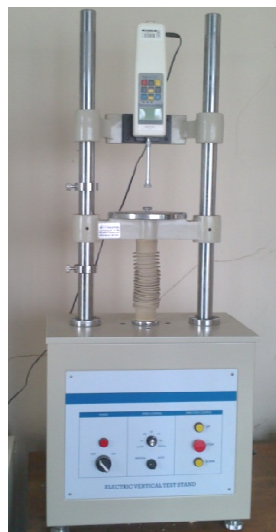
Figura 3.7. Il banco di prova dinamometrico utilizzato nell'ambito delle prove.
