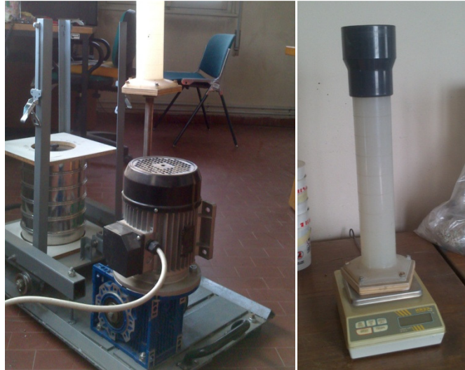
Figura 3.5. La macchina compattatrice (a sinistra) ed il cilindro graduato con il collare di contenimento (a destra).
