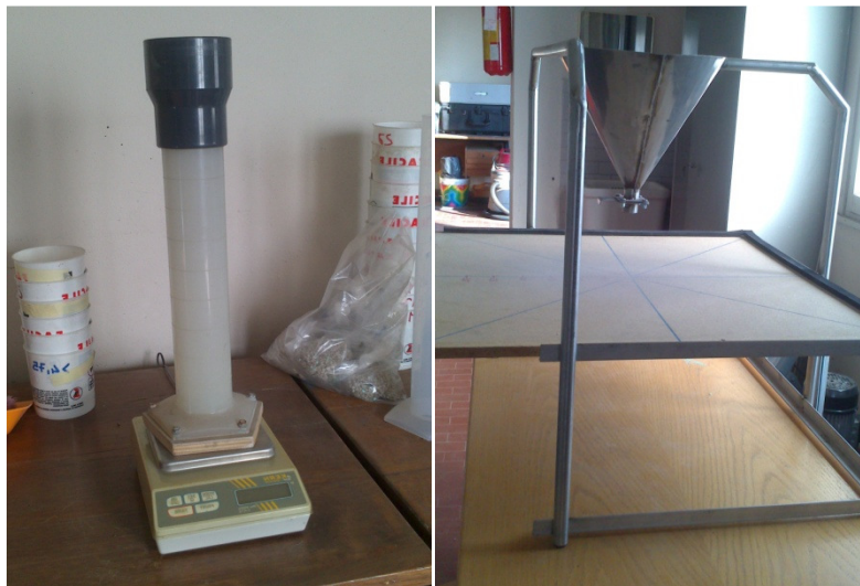
Figura 3.4. Il cilindro graduato (a sinistra) e l'imbuto (a destra) utilizzati nella prova per la determinazione della densità apparente senza compattazione.
