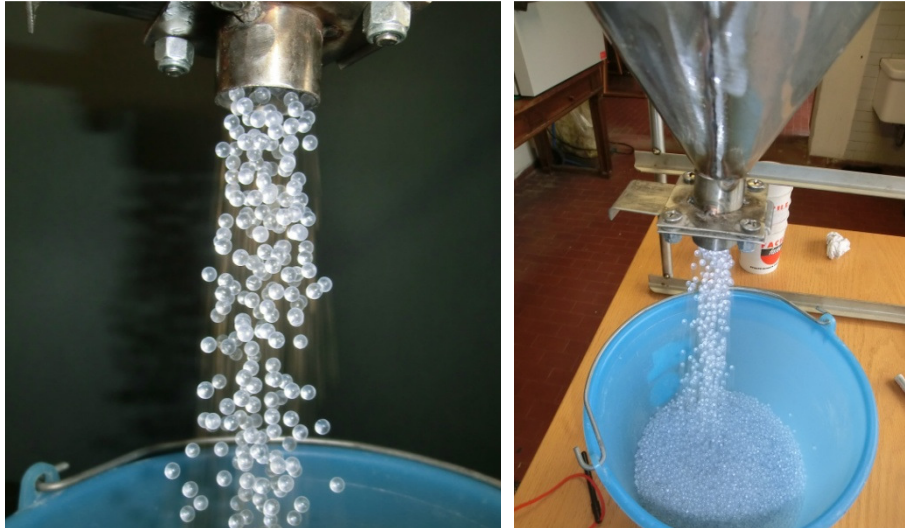
Figura 3.3. Prova di flusso con le sfere di vetro per la taratura del metodo di stima della scorrevolezza del concime.
