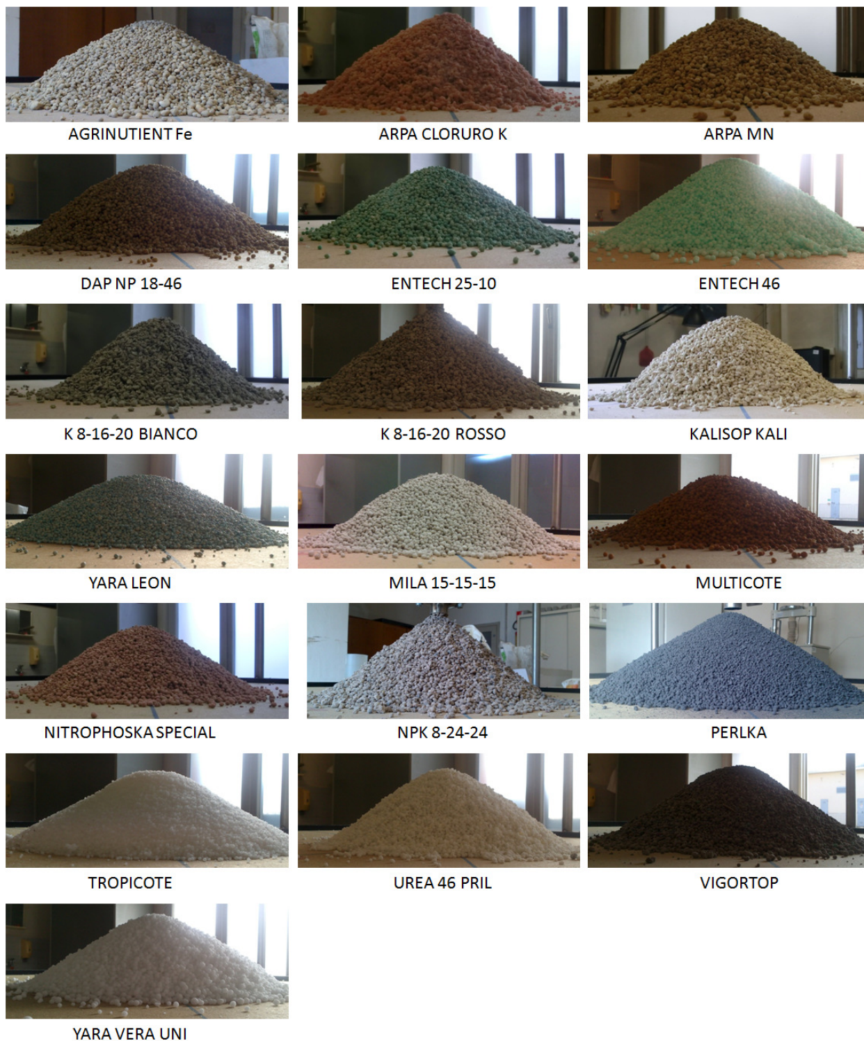
Figura 4.1. Foto rilevate dopo la prova per la stima dell'angolo di riposo statico per 19 dei concimi analizzati. I concimi Biorex e Gea Orto non sono inclusi in quanto la forma pellettata per il primo e l'elevata plasticità causata dall'alto tenore organico del secondo non hanno consentito la corretta esecuzione dei test.
