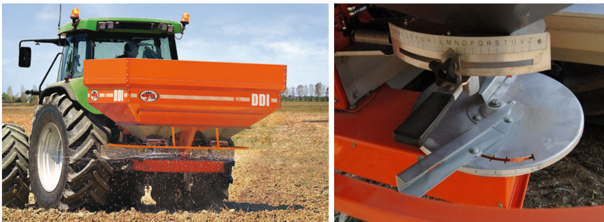
Figura 2.1. Esempio di macchine spandiconcime centrifuga (a sinistra) e dettaglio di un disco (a destra).
