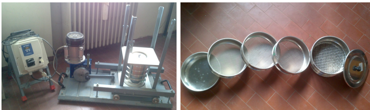
Figura 3.6. La macchina utilizzata per agitare meccanicamente i setacci (a sinistra) ed i 4 setacci utilizzati nell'ambito del presente lavoro di tesi (a destra).
