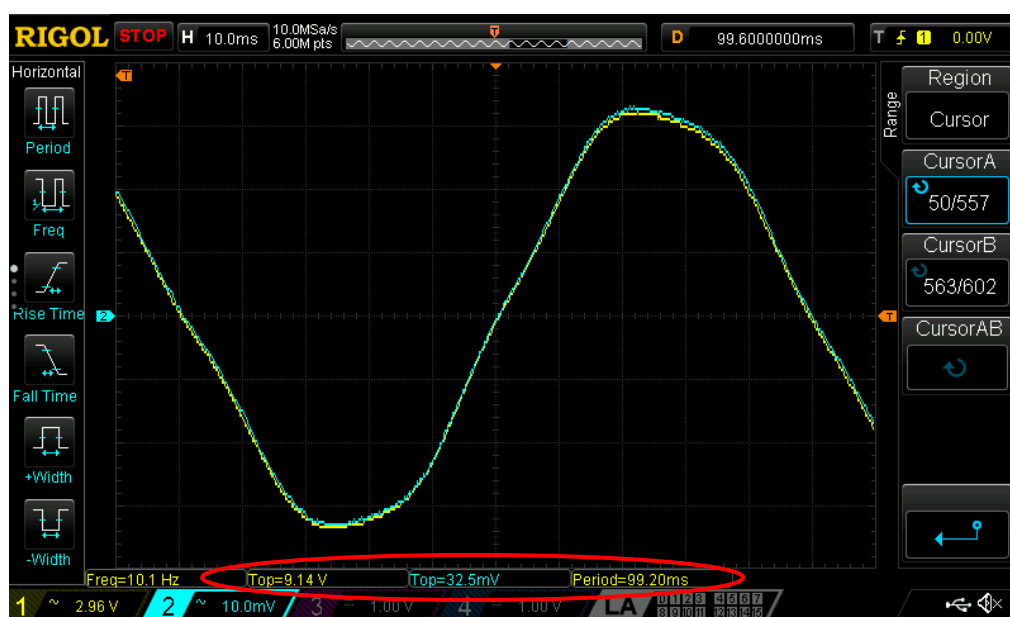
Figura 3.3: Esempio di forme d'onda di tensione e corrente con R_{load} = 30 [\Omega]
