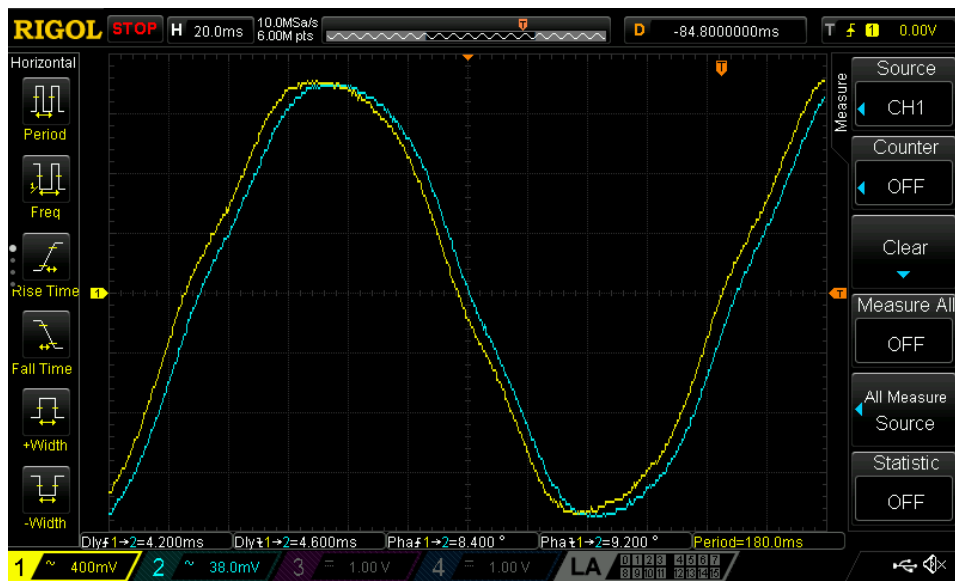
Figura 3.4: Esempio di forme d'onda di tensione e corrente con R_{load} = 15 [\Omega]
