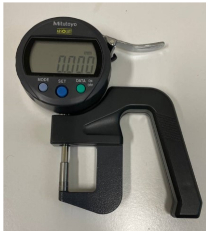
Figura 4.9: Spessimetro digitale Quick ABSOLUTE Digmatic Serie 547.
