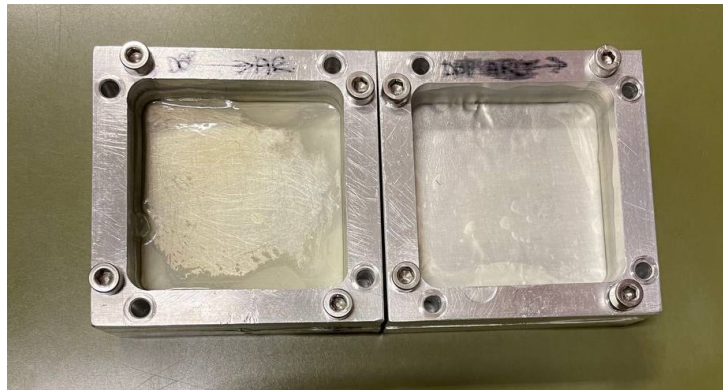
Figura 4.5: esempio di membrane ibride ottenute accoppiando pericardio bovino decellularizzato e ChronoFlex®. A sinistra è presente CFAR mentre a destra il CFARLT.
