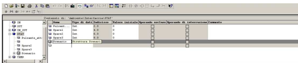
Figura 10. Struttura di dichiarazione per FB, aggiunta di variabili STAT
