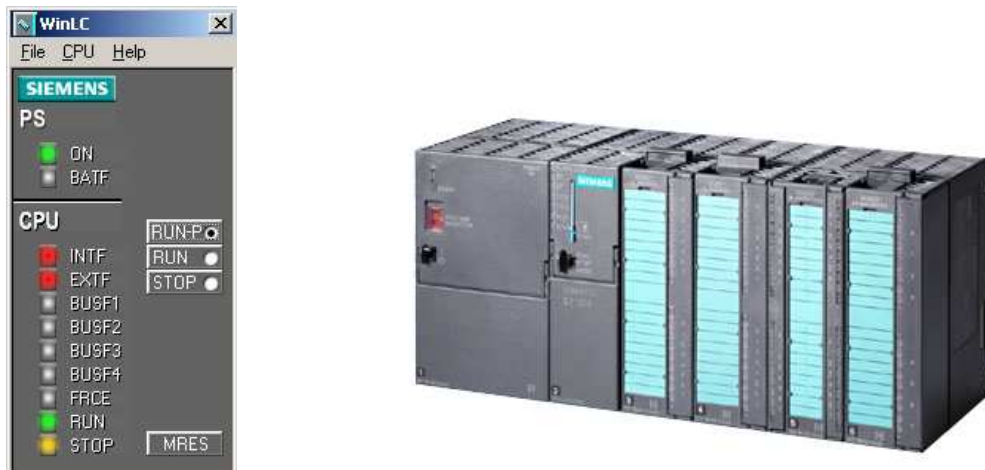
Figura 7. A destra PLC reale Siemens S7-300, a sinistra pannello di WinLC (PLC Software)
