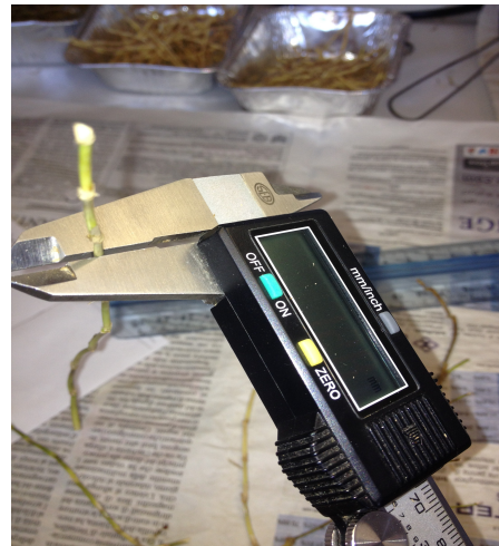
Figura 24: Misurazione del diametro di uno stolone con calibro
