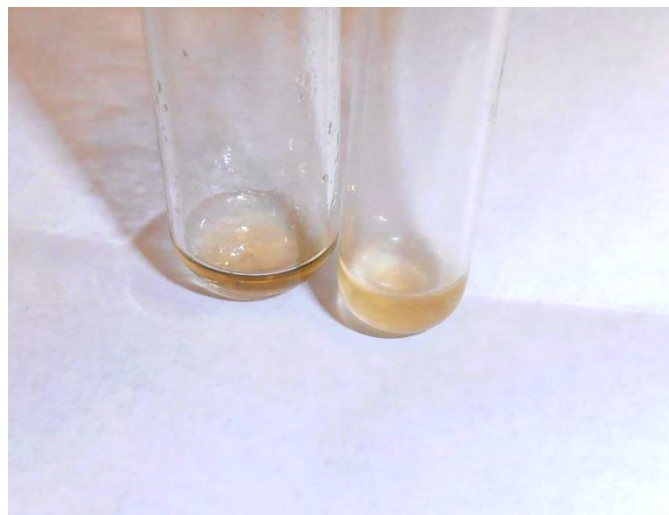
Figura 3.15 Provette contenente oli di pirolisi provenienti dal condensatore
