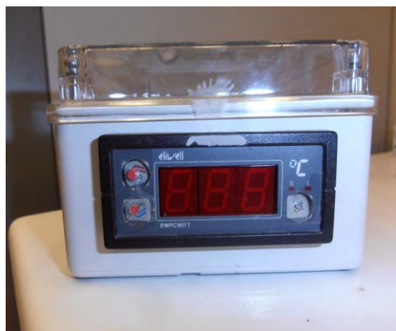
Figura 3.7 a) Regolatore automatico OMRON b) Regolatore manuale Eliwell
