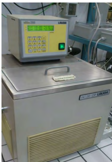
Figura 3.10. Chiller LAUDA utilizzato per termostatare il condensatore a 2°C.
