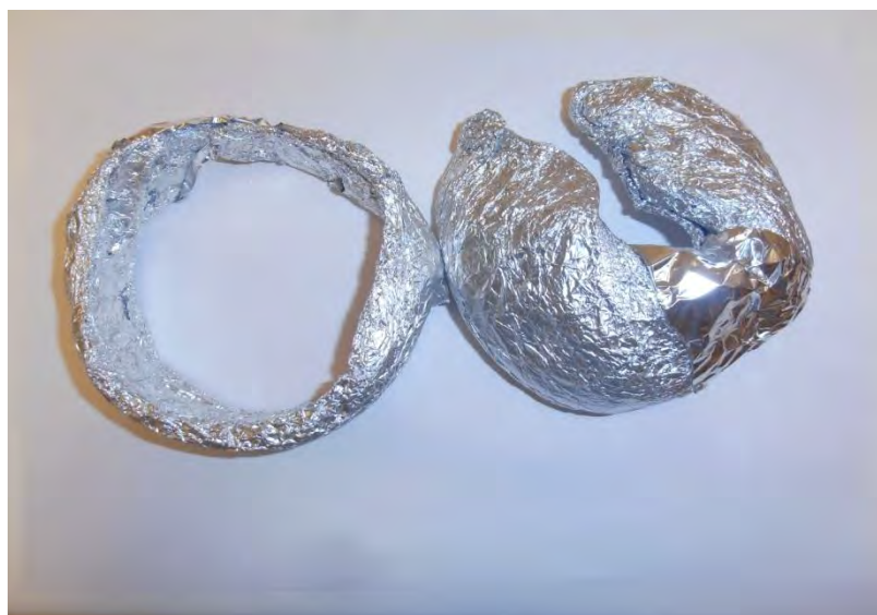
Figura 3.6 Elementi mobili di coibentazione per il tappo superiore (lana di quarzo rivestita da carta alluminio)
