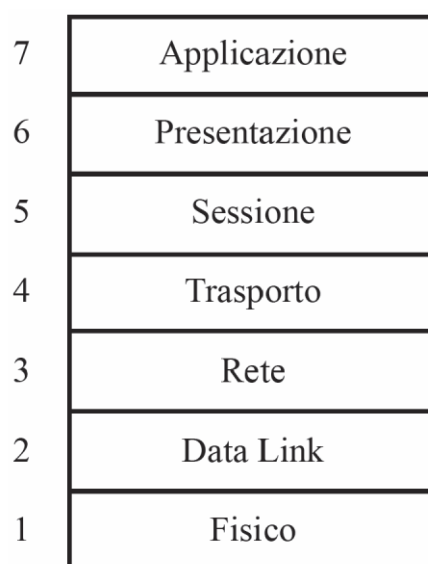
Figura 1.1: Layer del modello OSI secondo la rappresentazione a pila.
