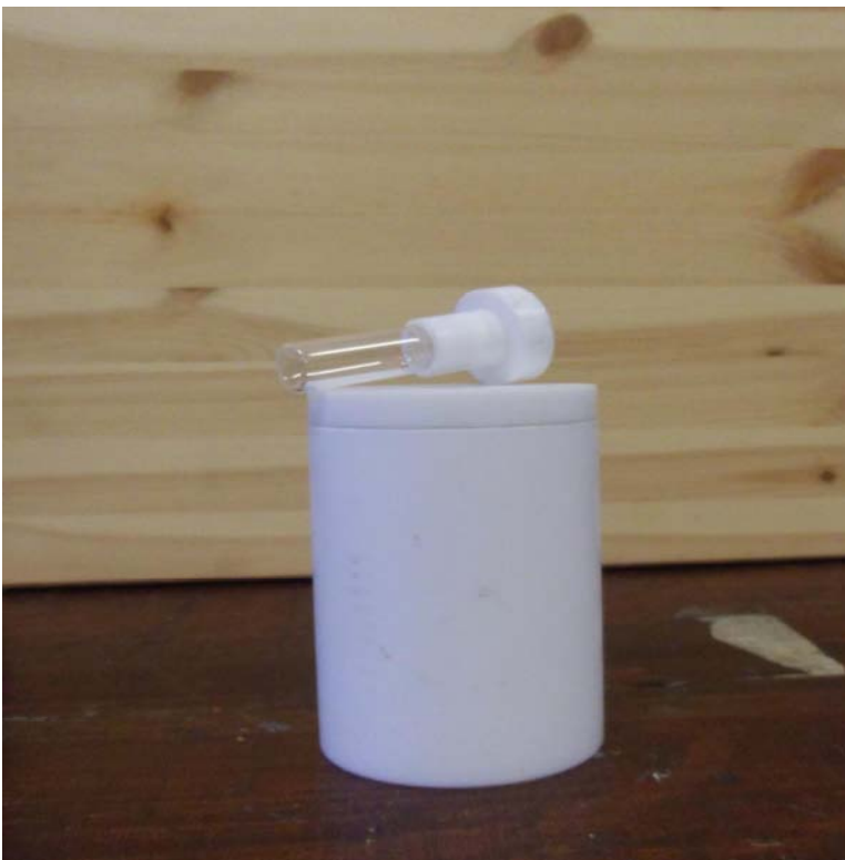
Fig.5.4 magnetofluido contenuto in un vial di vetro dentro al contenitore cilindrico cavo di teflon, senza isolamento termico ( isolamento ottenuto con aria ferma ): contenitore B.
