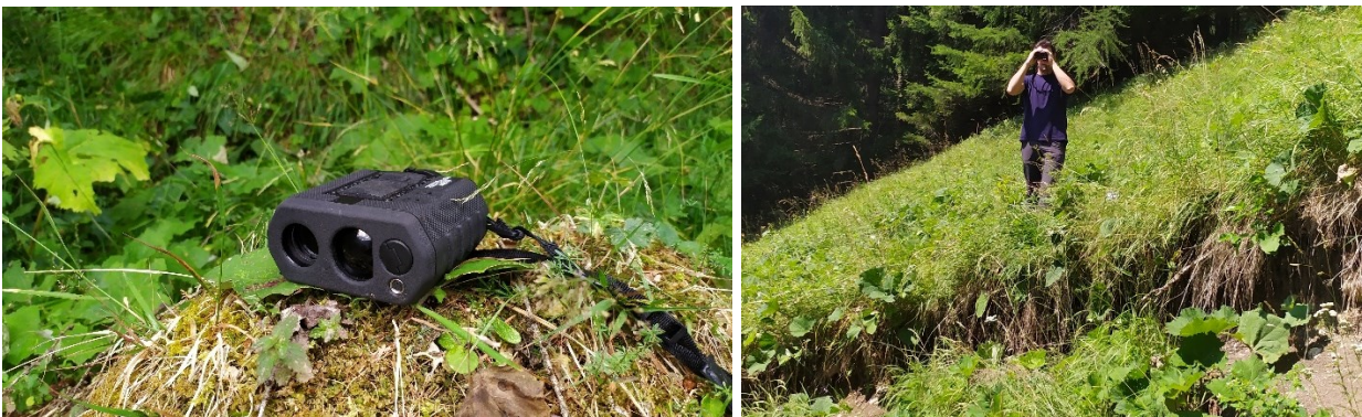
Figura 25: Misurazione in campo della profondità della frana tramite TruPulse.
