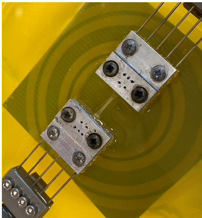
Figura 28: Dettaglio relativo alla prova in immersione del ChronoFlex ARLT.
