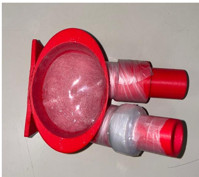
Figura 15: Vista laterale del prototipo del TAH. Si vede la camera ventricolare in silicone e i connettori usati per le prove a banco.
