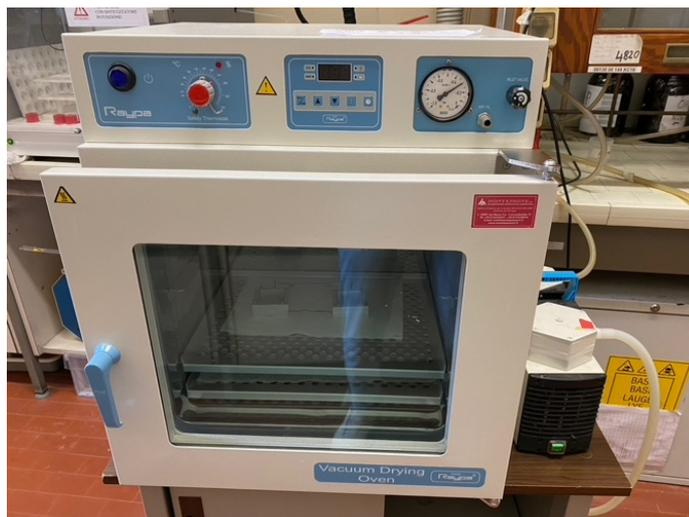
Figura 21: Membrane di Chrono – Flex<sup>®</sup> AR – LT nel forno Vacuum Drying Oven.
