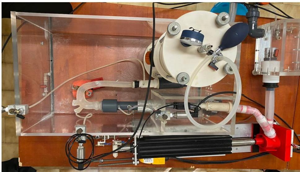
Figura 16: Prova a banco della nuova camera ventricolare.
