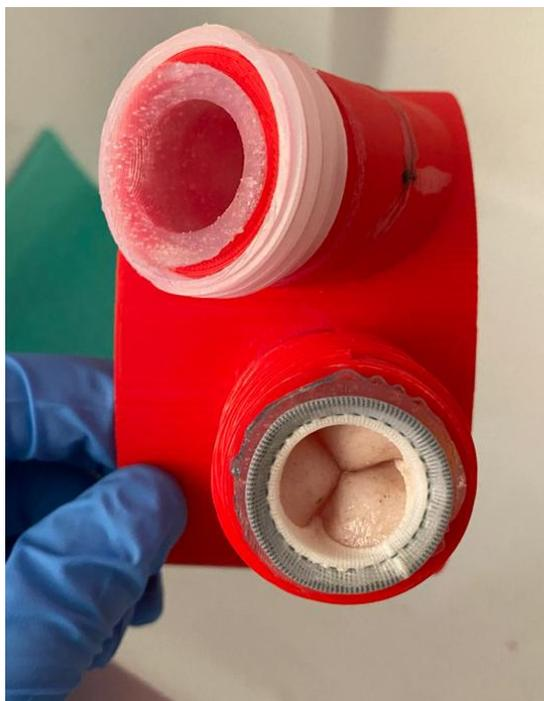
Figura 14: Vista dall'alto del prototipo del TAH. Si intravedono lo châssis, stampato in 3D in ABS (in rosso), la valvola cardiaca biologica di ingresso e la camera ventricolare in silicone.
