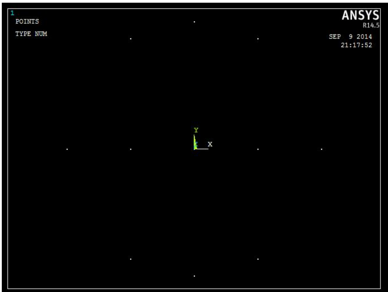
Figura 2.1 Creazione dei keypoints per definire la geometria.
