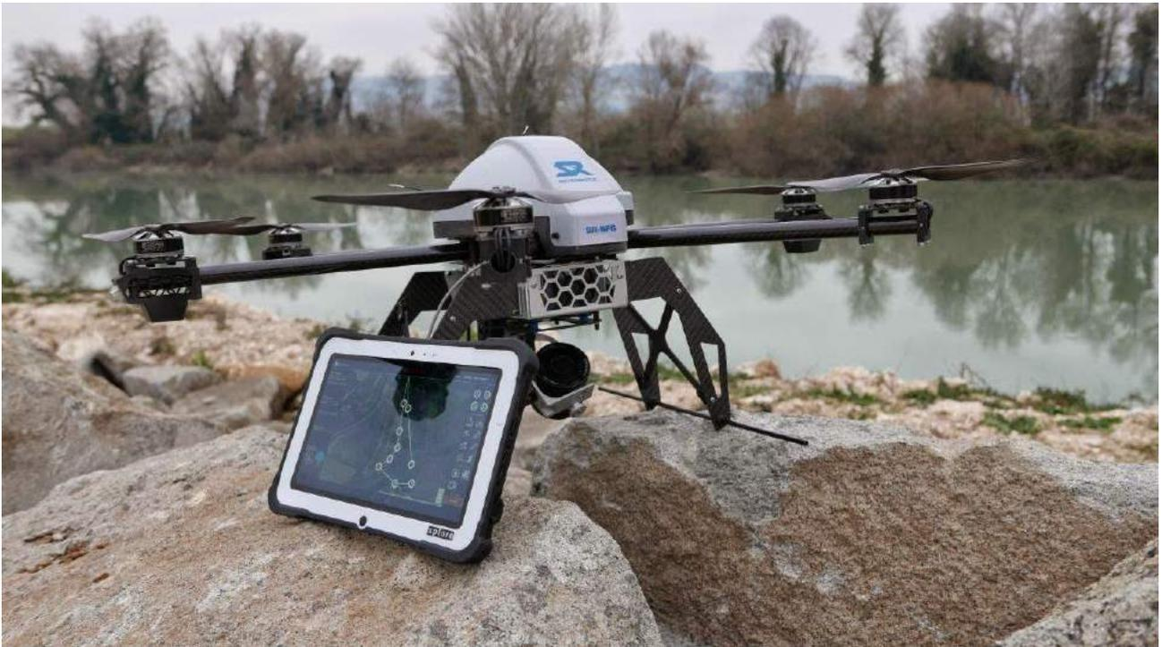
Figura 4. Drone usato per il telerilevamento
