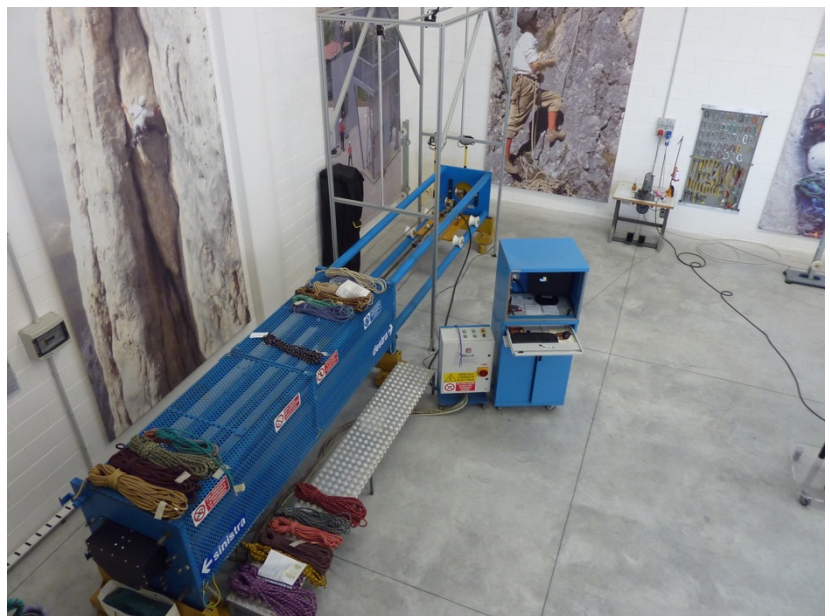
Figura 1-14 Banco prova a trazione lenta
