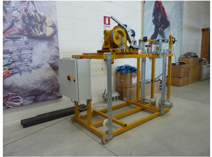
Figura 1-12 Apparato per usura delle corde da arrampicata
