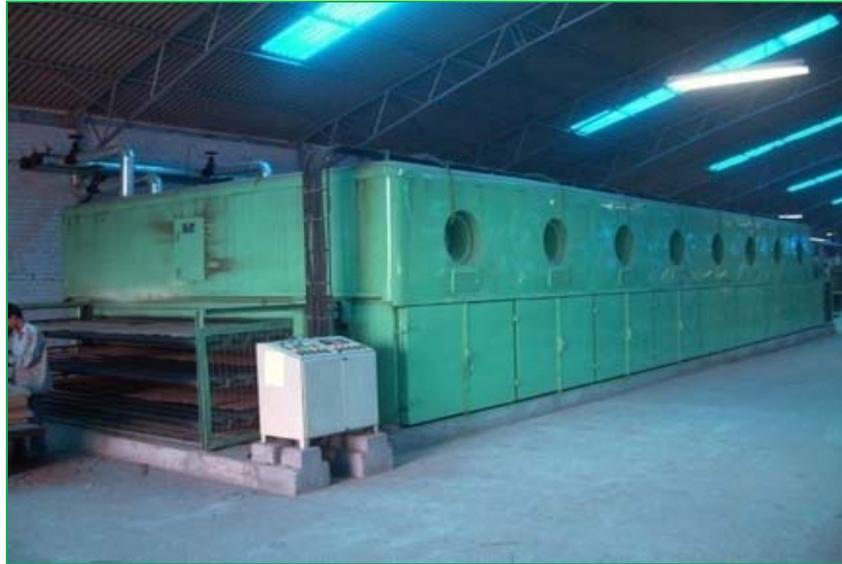
**Image 3.8** Exemple de séchoir à rouleaux
