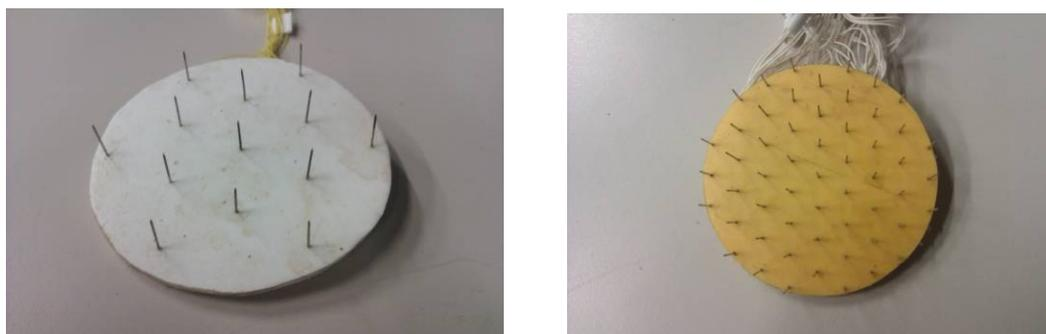
**Figura 4.9 a. Foto degli elettrodi da 3 cm, b. elettrodi da 2.5 cm, c. da 2 cm, d. da 1 cm.**
