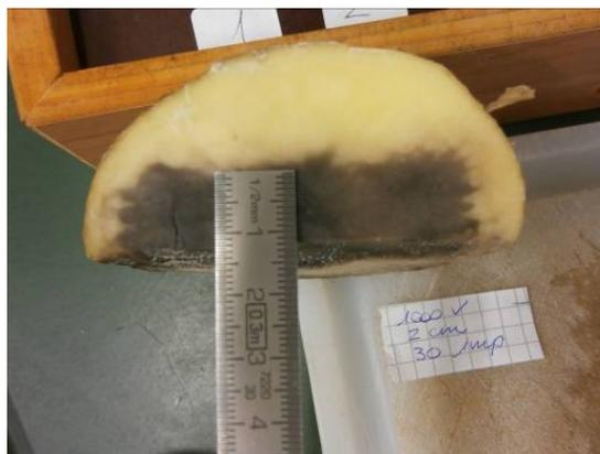
Figura 5.14 foto di esempio per la visualizzazione della profondità dell'elettroporazione.
