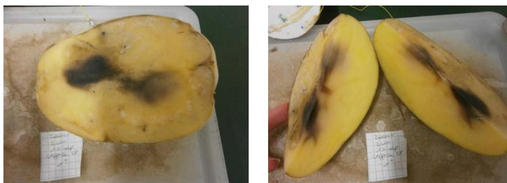
**Figura 6.74** patata dopo 24 ore dell'applicazione di 10 impulsi da 2000V agli aghi C-F.
