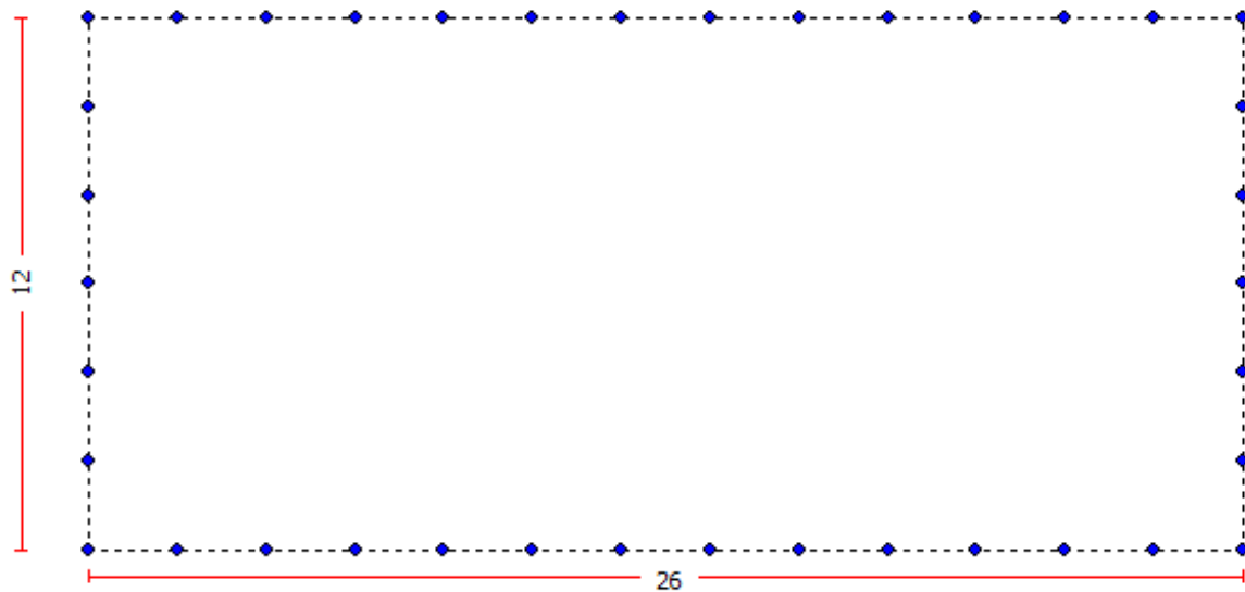
Figura 8.3.1.7. Configurazione rettangolare del campo sonde 26x12 m
