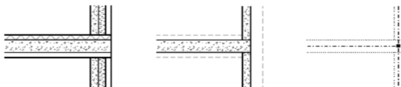
Figura 17 – Rappresentazione geometrica del modello architettonico, strutturale e analitico. Fonte: (T. Rácz & T. Olofsson, 2009).
