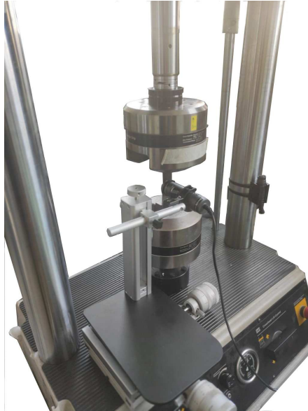
Figura 3.2: Apparato sperimentale utilizzato per osservare la cricca costituito da base di supporto e microscopio
