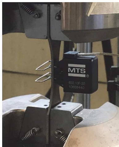
Figura 3.5: Estensometro posizionato nella zona di strizione del provino durante le prove di trazione statiche dei provini lisci
