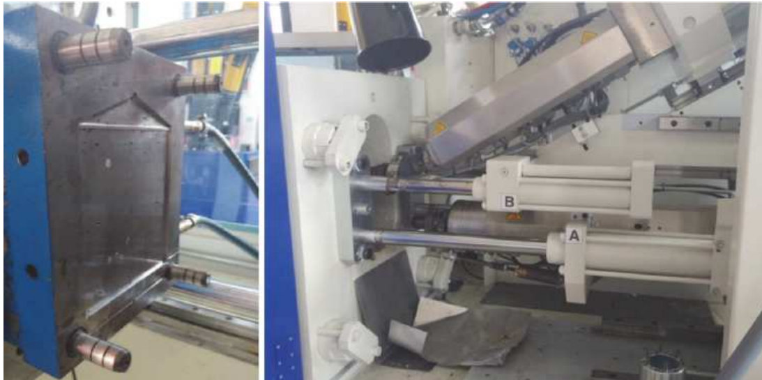
Figura 2.1: Immagini dell'interno della pressa: a sinistra lo stampo, a destra il gruppo di iniezione
