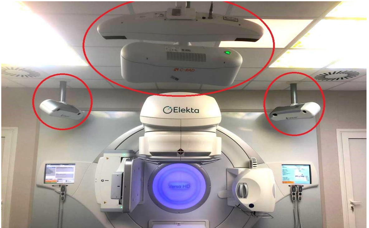
Fig. 4 Sistema Catalyst su acceleratore lineare (in rosso)
