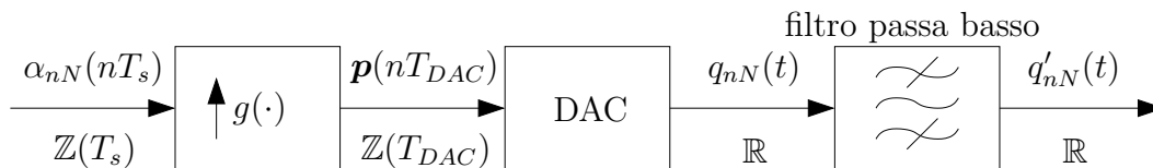
Figura 2.8: Schema equivalente dell'interpolatore.
