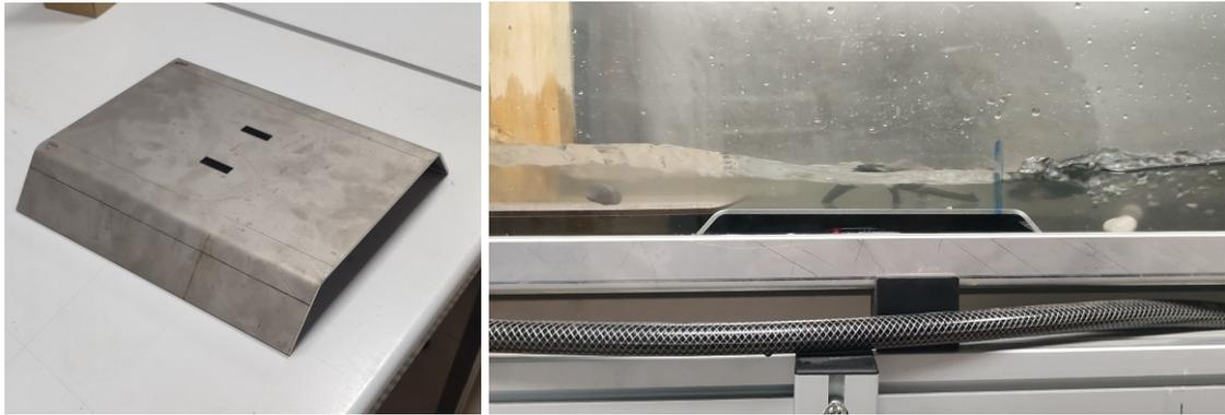
Figura 20: A sinistra, piastra in Acciaio Inox utilizzata durante le prove in laboratorio. La parte superiore misura 30cm x 20cm e l'altezza della struttura è di 4,5cm per consentire l'alloggio del sensore. A destra, sistema di registrazione durante i test in canaletta. Si riesce ad osservare la piastra con il registratore HydroMoth allacciato nella parte inferiore e il movimento dei ciottoli che passano sopra la struttura in acciaio.
