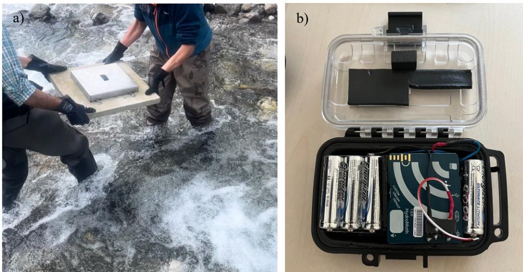
Figura 34: Posizionamento del sistema di monitoraggio ancorato ad una zavorra sul letto del torrente Cordon (a) e versione del sensore HydroMoth con batteria estesa (b).
