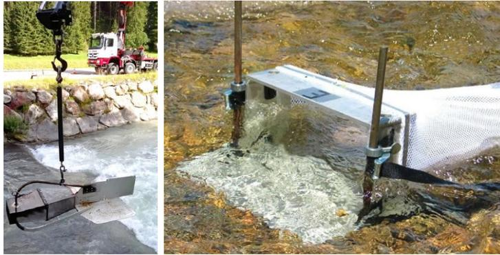
Figura 5: Campionatore Helley-Smith (a sinistra) (Geay et al., 2020) e trappola di Bunte (a destra) (Mao, 2011).
