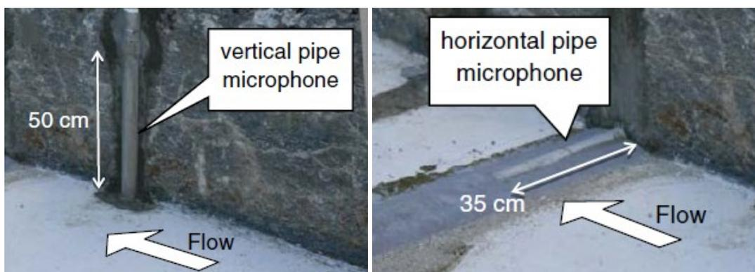
Figura 10: Microfono a tubo verticale (a sinistra) e microfono a tubo orizzontale (a destra) utilizzati da Tsutsumi et al. (2018) nel canale Ashi-arai-dani, nella catena montuosa di Hodaka (Giappone).
