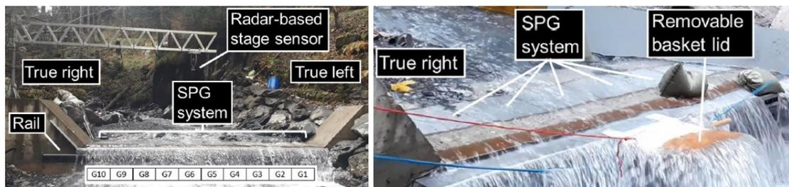
Figura 8: Stazione di monitoraggio in Vallon de Nant (Svizzera) in cui si può osservare la struttura in cemento che ospita il sistema SPG costituito da dieci piastre (a sinistra) e l'implementazione di una rotaia per spostare il campionario mobile di sedimenti sopra le singole piastre ai fini della calibrazione (a destra) (Antoniazza et al., 2022).
