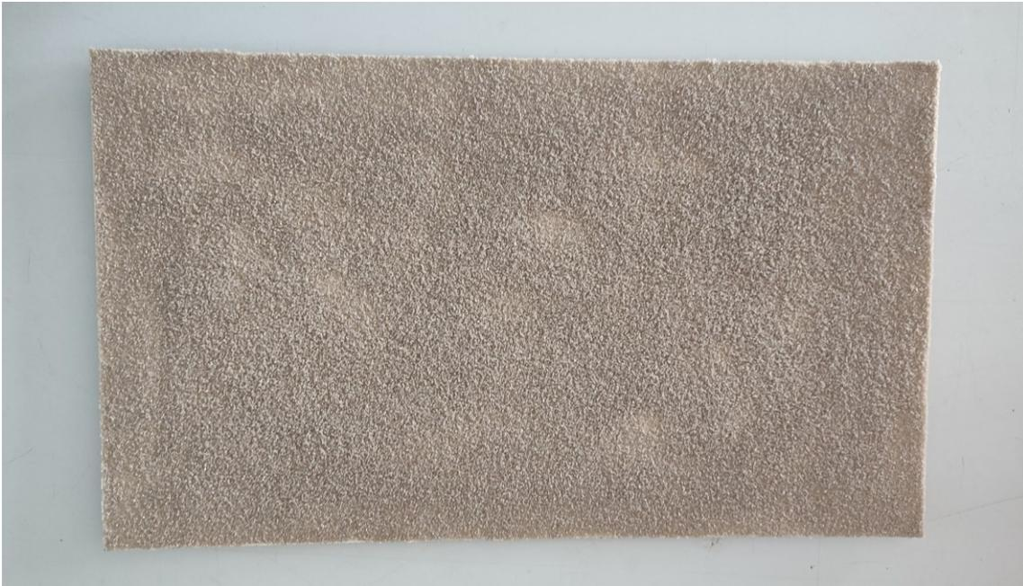
Figura 19: Pannelli in compensato sabbiati e posizionati sul fondo della canaletta per simulare delle condizioni di attrito naturali.
