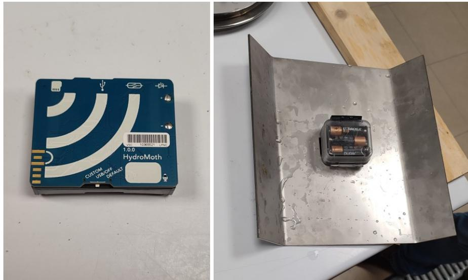
Figura 18: Registratore subacqueo “HydroMoth” senza custodia (a sinistra) e all’interno della custodia allacciata nella parte inferiore della piastra in Acciaio Inox (a destra).
