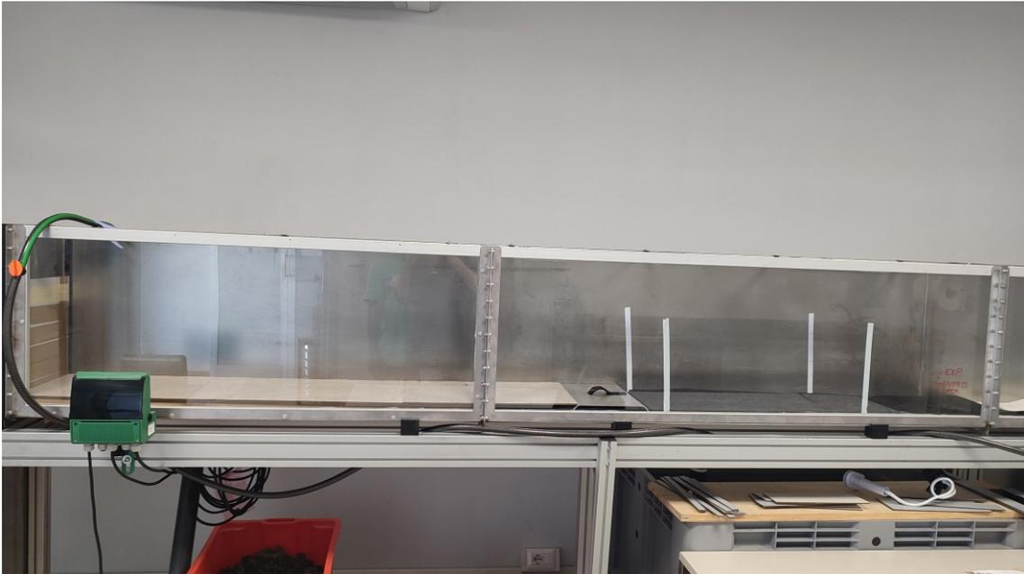
Figura 21: Configurazione della canaletta adottata durante le prove in laboratorio. Da sinistra verso destra si possono osservare: la paratoia verticale, i pannelli sabbiati, la piastra in Acciaio Inox e i tappeti in gomma.
