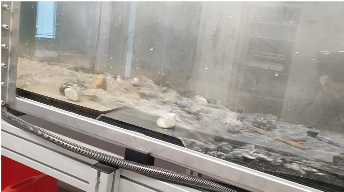
Figura 22: Momento dell'impatto dei sedimenti ricavato dalle registrazioni video dei test.
