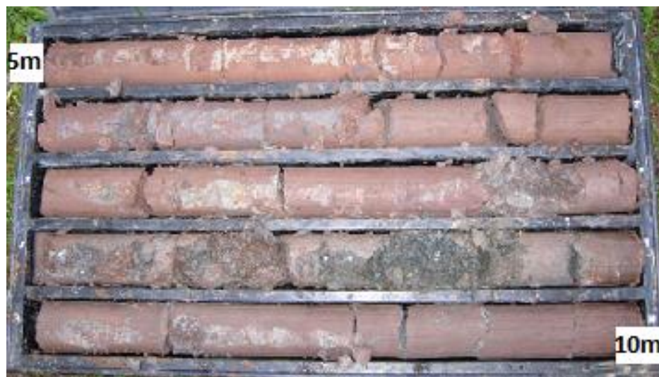
Fig. 14. Cassetta di carotaggio da 5m a 10m
