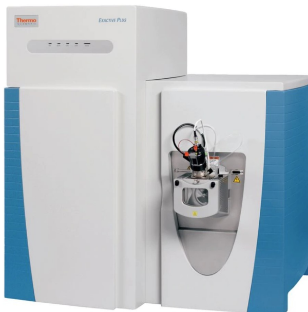
Figura 2.18: Modello dello spettrometro utilizzato in questa tesi. Lo ionizzatore è sostituito con il DART
