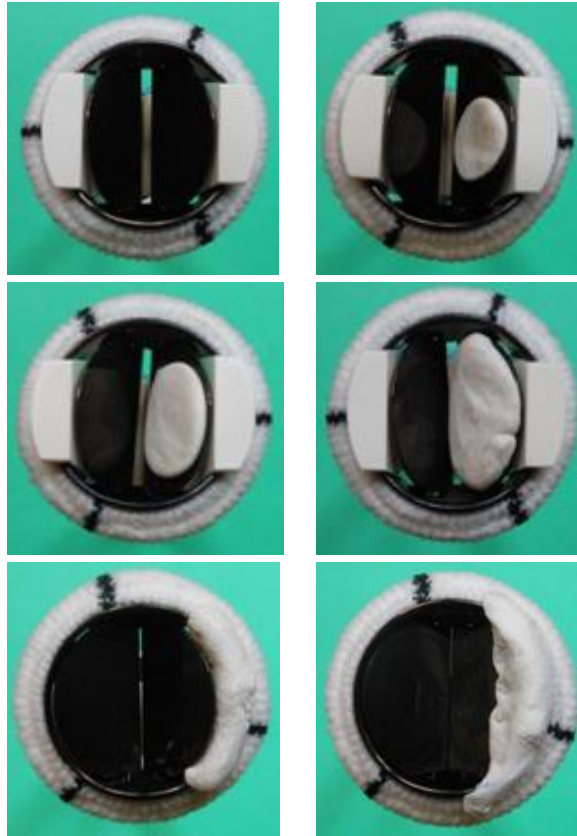
Figura 4.2: Valvola ATS Open Pivot: dettaglio del posizionamento dei trombi nelle sei diverse condizioni di funzionamento. Procedendo da sinistra a destra e dall'alto in basso, si vedono le classi Nf e T1, le classi T2 e T3 e le classi Hg e Bk.
