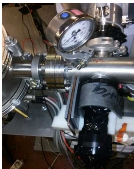
Figura 15. Isolamento da raggi X effettuato tramite listelle di Piombo sul fototubo PMT2 con il filtro a 120 nm
