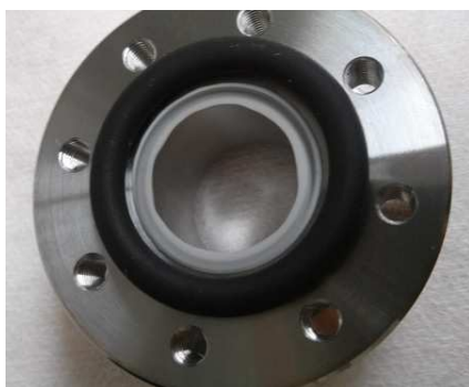
Figura 9. Finestra di MgF_2 inserita ed incollata in flangia da vuoto
