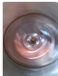
Figura 4. Finestra di Havar che separa il volume della camera dal volume a monte, dove si propaga il fascio di protoni
