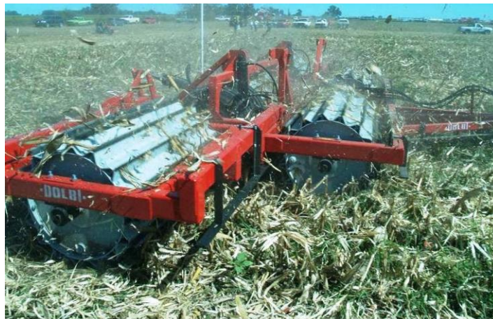
Figura 7. Rullo decespugliatore utilizzato per il trattamento dei residui. Può essere montato anche anteriormente per la devitalizzazione di cover crop
