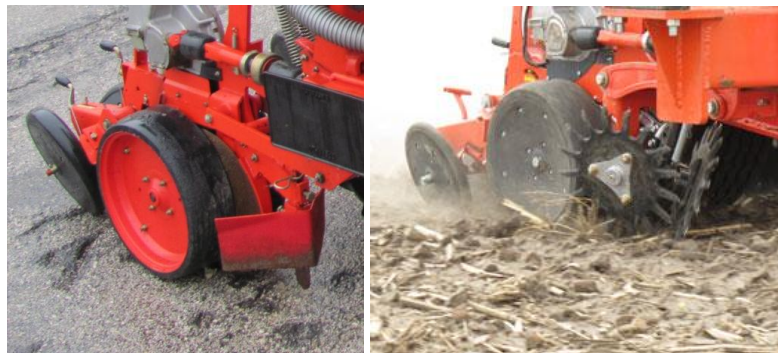
Figura 25. Utensili spostaresiduo. Nel primo caso sono montati vomerini spostaresiduo, mentre nel secondo una coppia di ruote stellate libera la linea di semina da abbondanti residui
