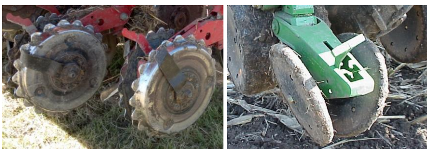
Figura 26. Elementi chiudisolco costituiti da una coppia di ruotini a V. L'inclinazione sul piano verticale consente di riportare sulla linea di semina una maggior frazione di terreno smosso dall'assolcatore, accentuato da utensili a margine dentato come quelli di sinistra
