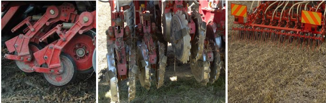
Figura 23. Elementi chiudi solco costituiti da ruotino singolo, doppi ruotini con margine interno dentato, e denti elastici. In base alle condizioni è importante la loro regolazione al fine di avere una più omogenea emergenza successiva
