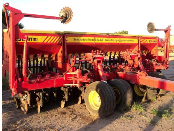
Figura 19. Seminatrice da sodo a righe, in versione trainata, con assolcatori a disco. Le singole unità di semina comportano un certo peso della macchina. Opportune modifiche permettono in questo caso di effettuare con la stessa macchina, anche la semina del mais
