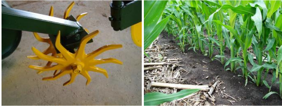
Figura 31. Row cleaner. A destra il residuo scalzato dalla linea di semina permette di migliorare l'emergenza
