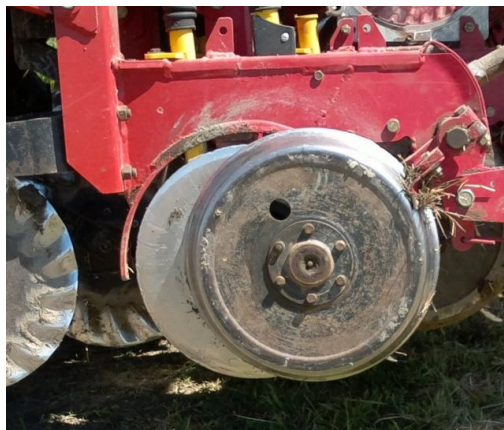
Figura 21. Assolcatore a doppio disco affiancato da ruote di profondità
