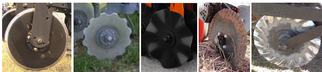
Figura 20. Principali tipologie di disco taglia residuo: (da sinistra) liscio, dentato, ondulato radiale, ondulato radiale corrugato nella parte esterna, ondulato tangenziale. La scelta è determinata in base all'obiettivo che si intende perseguire, aggressione del residuo e intensità della lavorazione del terreno
