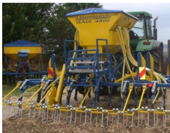
Figura 22. Seminatrice da sodo con assolcatori a dente. Richiedono una bassa potenza e si adattano a terreni ricchi di scheletro
