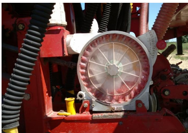
Figura 38. Sistema di distribuzione pneumatico in pressione, particolare di una placca di semina trasparente
