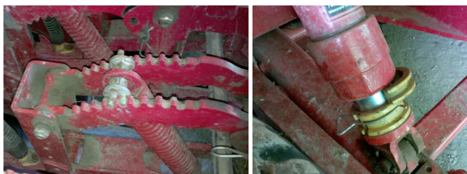
Figura 37. Molle di carico con le diverse posizioni possibili. A lato gli anelli che vanno a variare la corsa dei due martinetti idraulici
