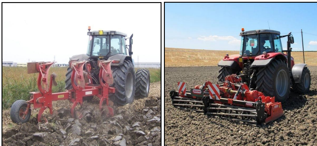
Figura 1. Principali lavorazioni tradizionali, con aratro trivomere (a sinistra) e con erpice rotante (a destra)
