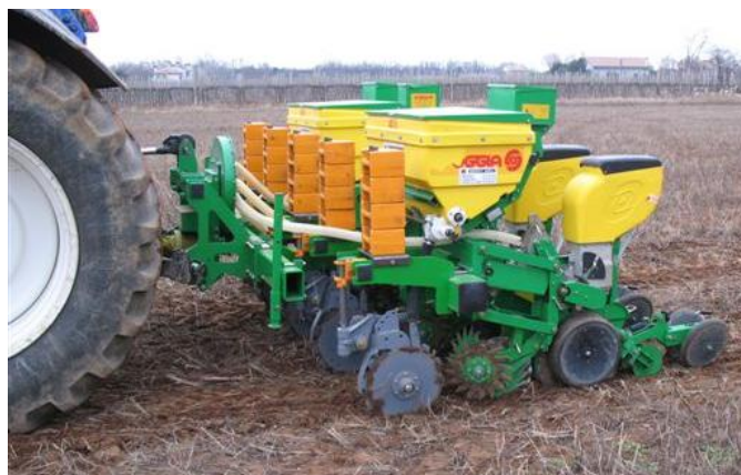
Figura 24. Seminatrice da sodo di precisione. Da notare la possibilità in questo caso di spostare il residuo nell'interfila potendo così accorciare le distanze tra gli utensili e ottenere una maggiore efficienza
