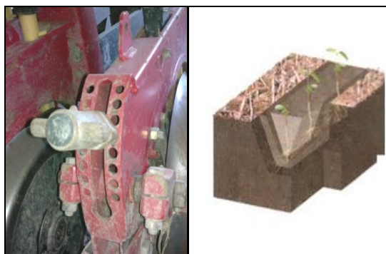
Figura 32. Perno di regolazione della profondità di semina e conformazione del solco
