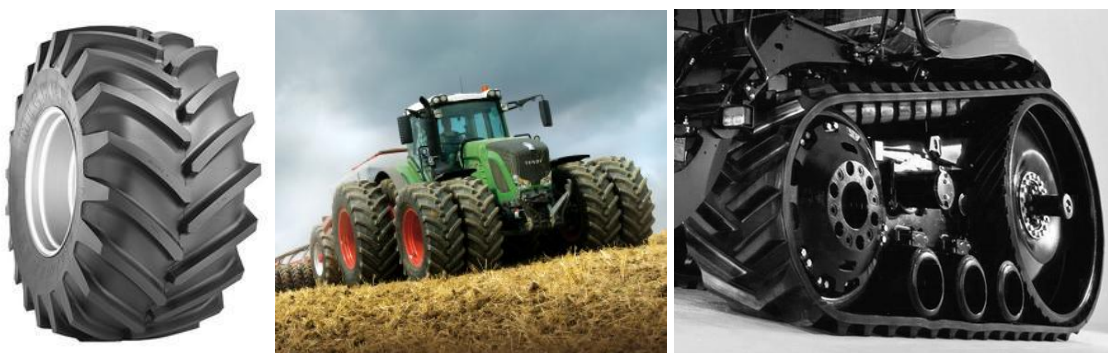
Figura 8. Alcune soluzioni adottate per ridurre il compattamento: pneumatici a larga sezione, gemellatura, cingoli
