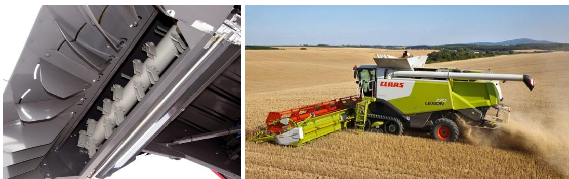
Figura 5. Particolare del trinciapaglia montato su una mietitrebbia. La paglia in questo modo viene distribuita su tutto il fronte di lavoro agevolando le successive operazioni.
