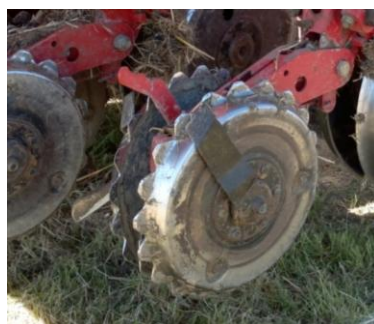
Figura 34. La regolazione dell'angolo di attacco avviene mediante bullone, mentre la pressione esercitata sul terreno viene variata posizionando la leva nelle diverse sedi
