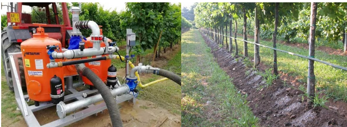
Figura 6-7: Sulla sinistra (figura 6) si può vedere un impianto di filtrazione e pompaggio utilizzato in impianti di micro-irrigazione a goccia; nella destra invece è raffigurato un impianto di irrigazione a goccia su un vigneto, si può notare come le gocce d'acqua cadano vicino alle piante creando degli aloni in prossimità delle radici (immagini illustrative, fonte: web)
