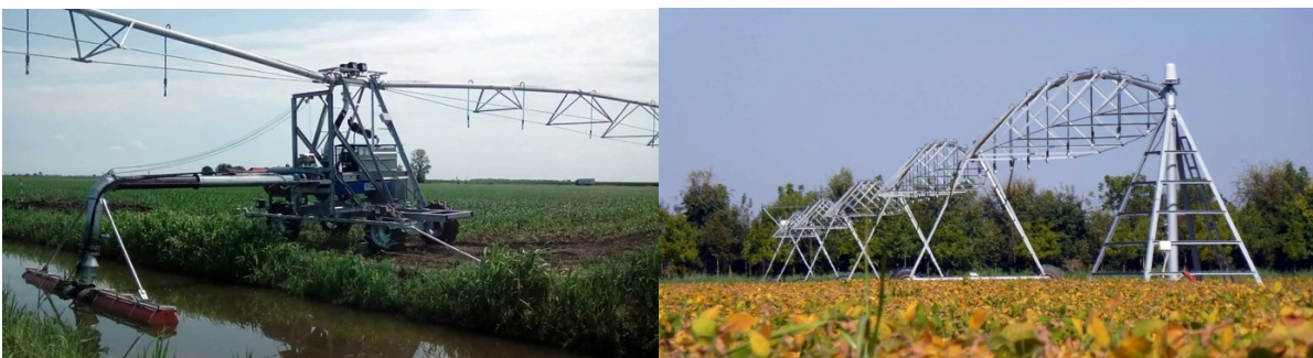
Figura 4-5: esempi di due sistemi fissi per irrigazione, sulla sinistra un sistema Rainger e sulla destra un sistema Pivot (fonte immagini: sito web irrigazione veneta: https://www.irrigazioneveneta.com/impianti/#pivot ).
