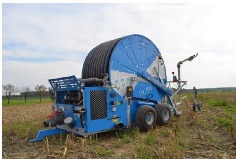
Figura 3: esempio di rotolone utilizzato per l'irrigazione dei terreni, in quanto caso si tratta del modello VIR8AM di Ocmis di un gruppo con motore e pompa già inclusi nel carrello. (fonte immagine: sito web Ocmis: https://www.ocmis-irrigazione.it/en/hose-reels/vir8am )
