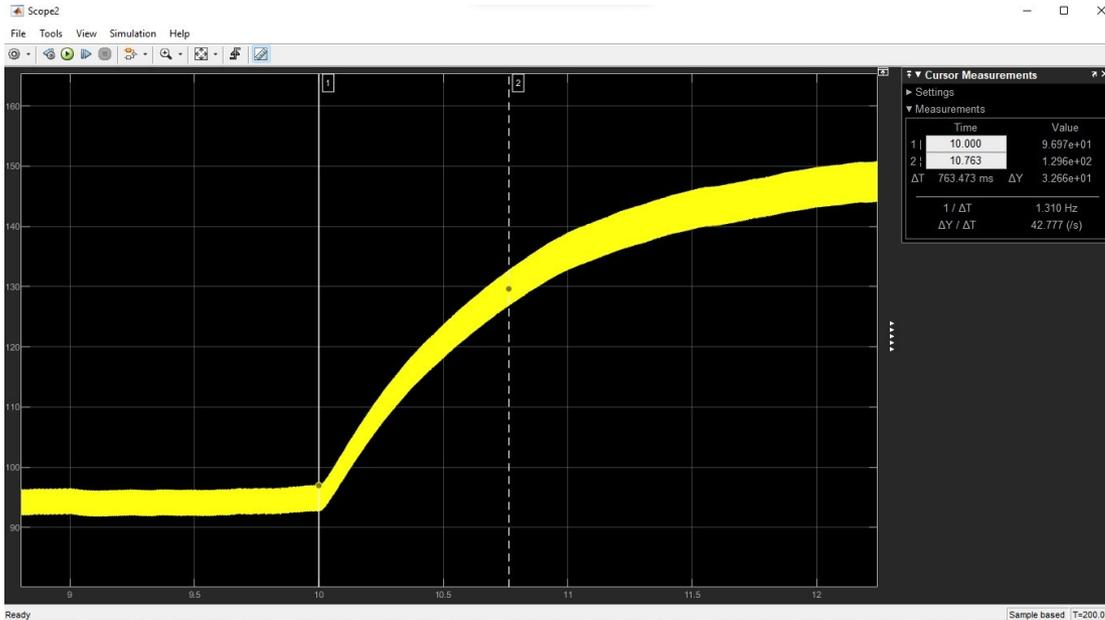
Con l'utilizzo di cursori, il primo a velocità  $\cong 95 \text{ rad/s}$ , il secondo al 63% della variazione totale ( $\Delta t_{\text{tot}}=55 \text{ rad/s}$ ), si ottiene come variazione di tempo:
