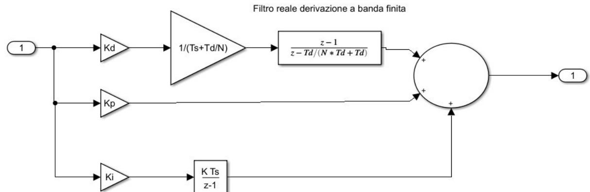
Si noti come discretizzando si può incorrere nell'errore di fase alla frequenza di attraversamento  $w_{gc}$
