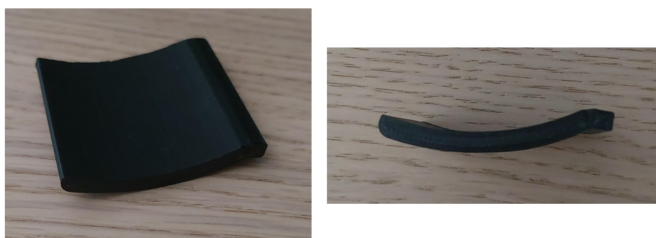
Figura 4.15: Esempio di lama circolare. È possibile notare la zona rettangolare posta all'estremità che permette l'incastro della lama con il mozzo.
