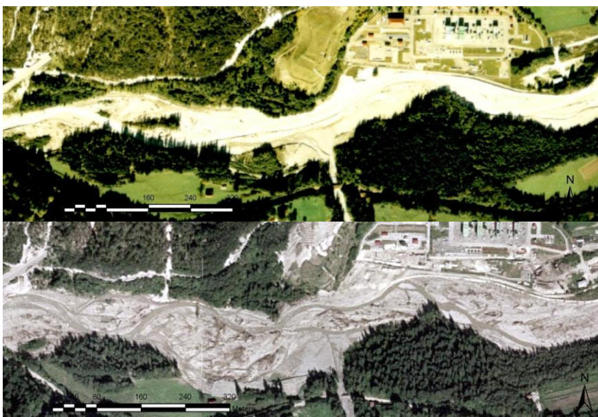
Figg. 67a, 67b: tratto del Fella presso Santa Caterina (Malborghetto) in foto aerea del '99 (sopra) e in ortofoto del '03 (sotto), in evidenza in quest'ultima il forte apporto di sedimenti e l'aumento di larghezza dell'alveo
