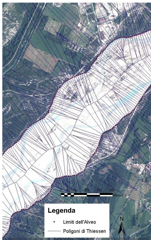
Fig. 12: poligoni di Thiessen realizzati per la determinazione dell'asse dell'alveo, la cui forma è intuibile lungo il tratto rappresentato; i poligoni di Thiessen sono definiti come luogo di punti equidistanti da una serie di punti scelti: nel caso di studio, i punti utilizzati sono quelli lungo i margini dell'alveo
