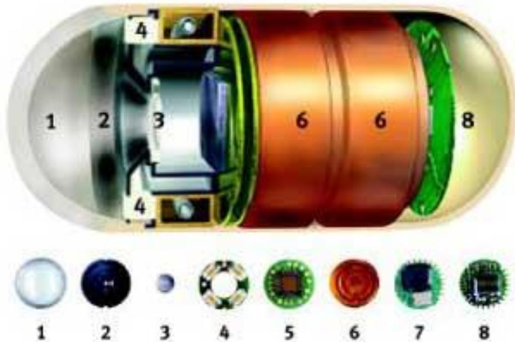
Figura 23 Capsula endoscopica. Si possono distinguere: 1) cupola ottica, 2) fermo per la lente, 3) Lente, 4) illuminazione a LED, 5) acquisizione immagini a CMOS, 6) batterie, 7) trasmettitore ASIC, 8) antenna
