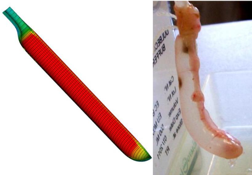
Figura 52 Campione deformato relativo al modello a elementi finiti (a) e relativo alla prova sperimentale (b)
