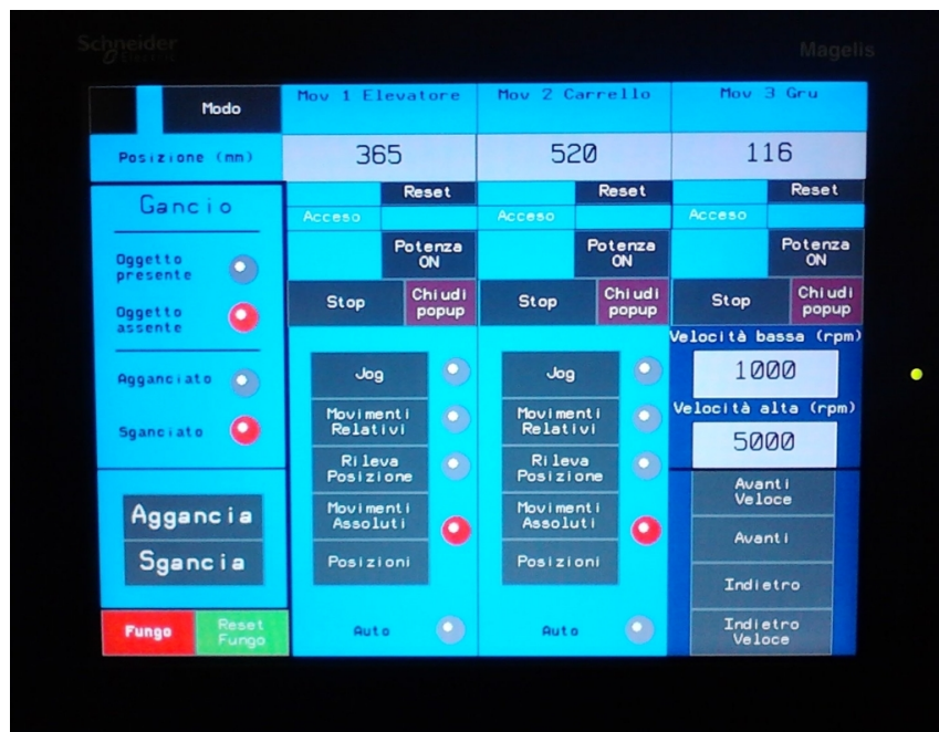
Fig. 4.19: Pannello per il controllo manuale, visualizzato sullo schermo touchscreen, con aperto il popup per il controllo della gru nel modo jog
