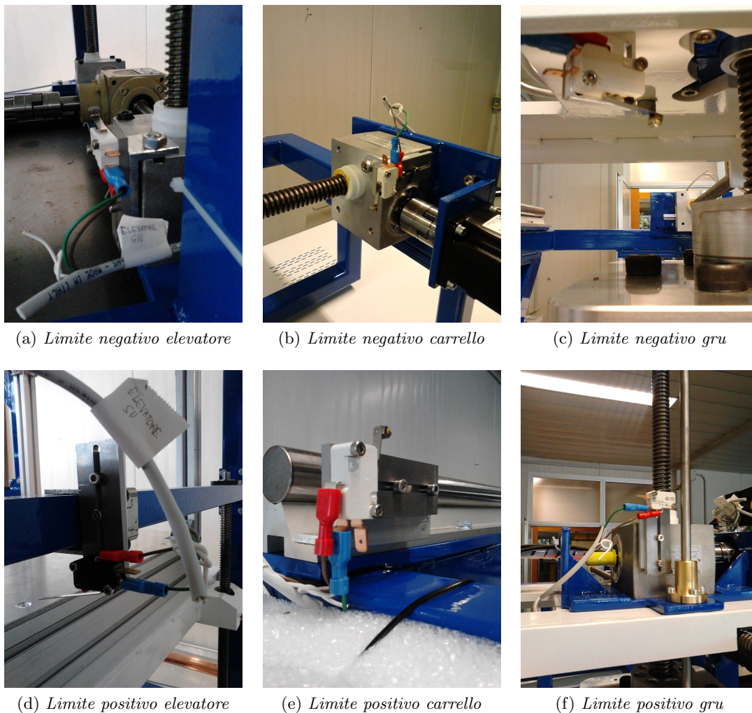
Fig. 2.30: Finecorsa montati sul cartesiano
