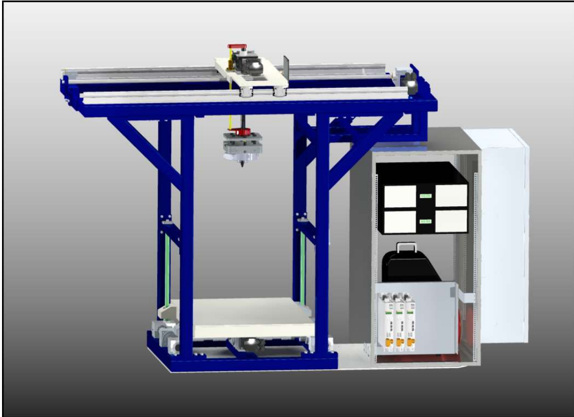
Fig. 2.2: Cartesiano e armadio dei controlli
