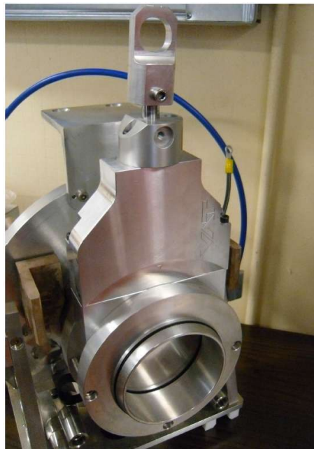
Fig. 1.26: Valvola VAT installata sulla camera
