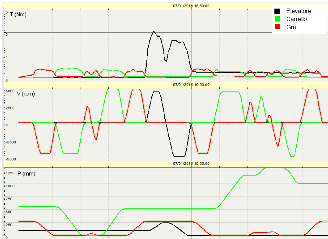
Fig. 6.2: Grafico relativo alle grandezze monitorate durante la sequenza per di deposito della camera target
