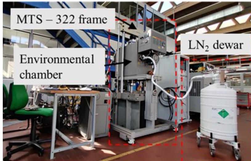
Macchina di prova per prove di trazione MTS-322
