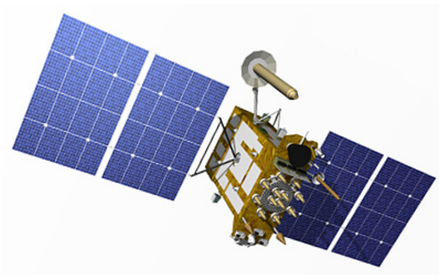
Figura 2.7: Satellite URAGAN-K, l'ultimo della generazione GLONASS: a bordo è dotato della strumentazione del sistema internazionale di ricerca e salvataggio
