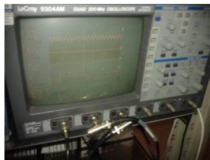
Figura 4.19: L'oscilloscopio per la lettura dei segnali provenienti dai fotodiodi e dal generatore
