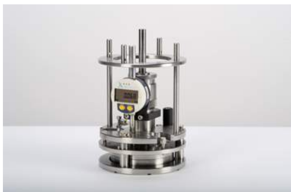
Figura 3.13: Il jig utilizzato per levigare il niobato di litio
