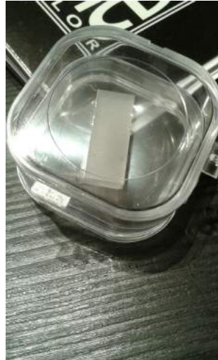
Figura 3.15: Il blocco in niobato di litio che useremo come mezzo attivo della LEO
