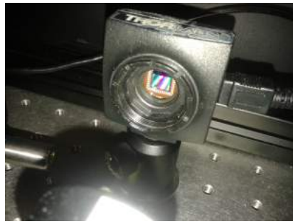
Figura 4.14: La telecamera CCD utilizzata per monitorare il segnale trasmesso
