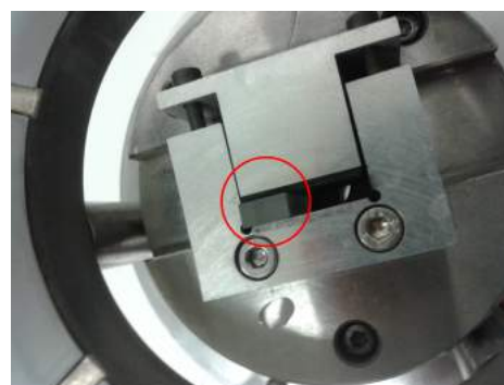
Figura 3.14: Il blocchetto in LiNbO 3 stretto nell'alloggiamento per il campione del jig [30]
