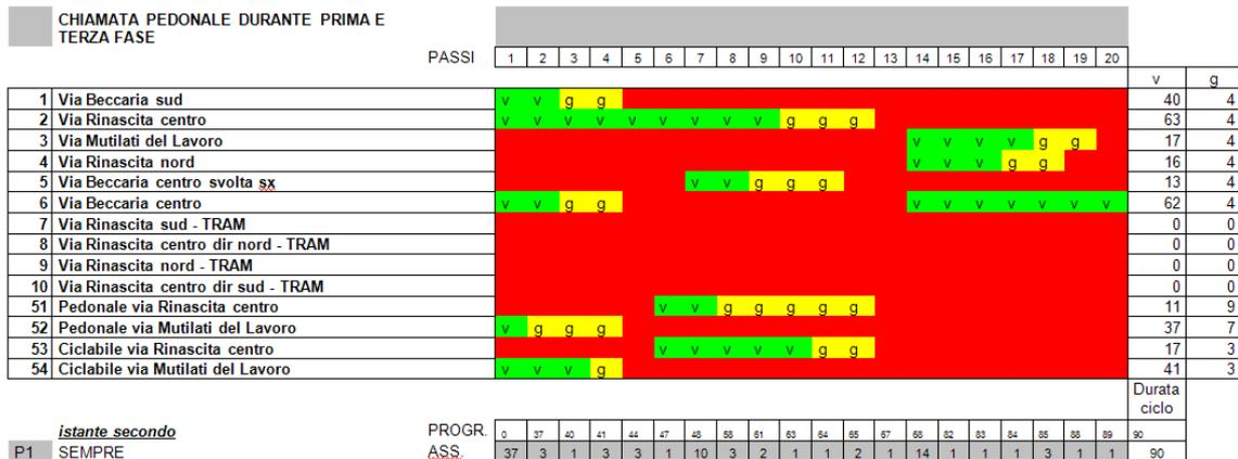
Fig. 2.30 – Piano semaforico per l’intersezione oggetto di studio in presenza di chiamata pedonale durante la prima oppure la terza fase del ciclo
