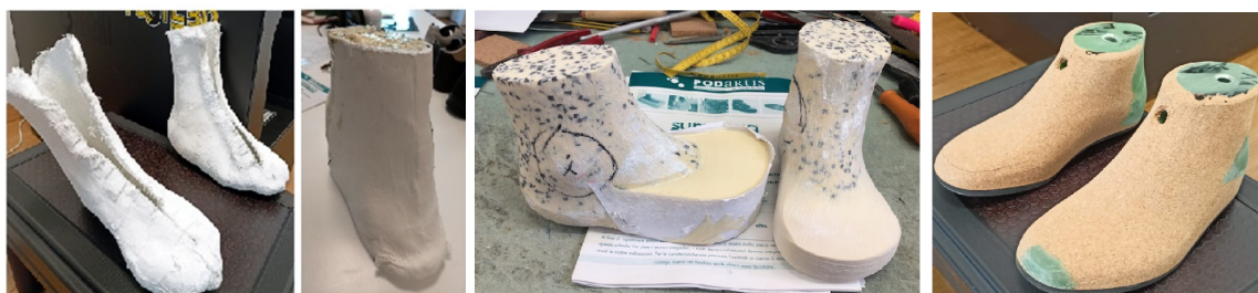
Figura 5.2: Da destra a sinistra: calco negativo, calco positivo, forma custom in lavorazione, forma custom finita.
