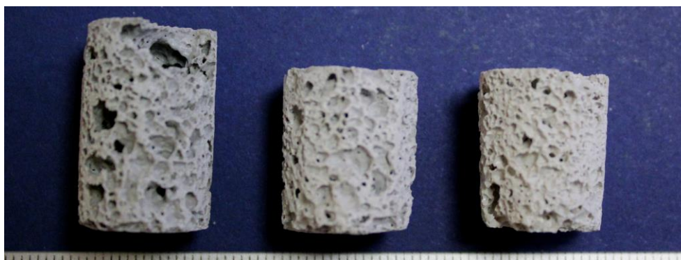
Figura 4.10. Campioni 25 mol% HT - 75 mol% OK, 50 mol% HT - 50 mol% OK, 75 mol% HT - 25 mol% OK, schiumati e reticolati a 380 °C per 30 min.
