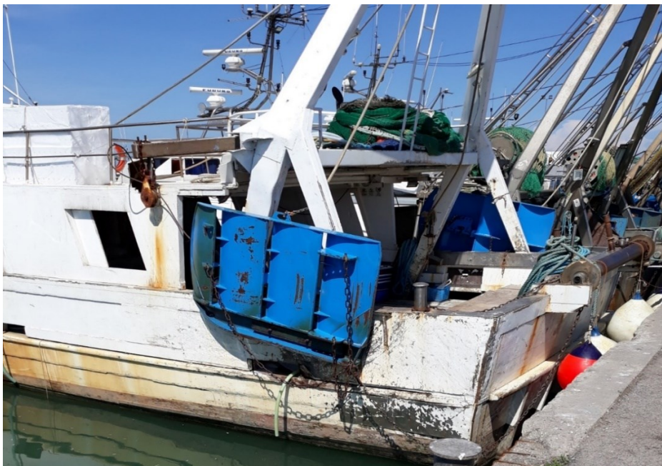
Figura 1.8. Veduta di poppa di una imbarcazione da strascico bentonico, a lato i divergenti di colore blu (foto di Emma Tiengo).
