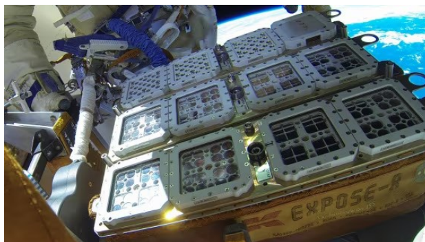
Figura 3.1 Esperimento BIOMEX, colture batteriche in MG (Fonte: NASA)
