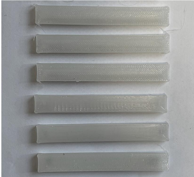
**Figura 7.12:** Prove preliminari TPU con diverse temperature, velocità e angoli di riempimento per la costruzione del DoE
