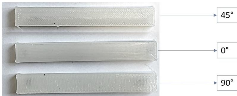
**Figura 7.13:** Campioni con indicazione degli angoli di riempimento
