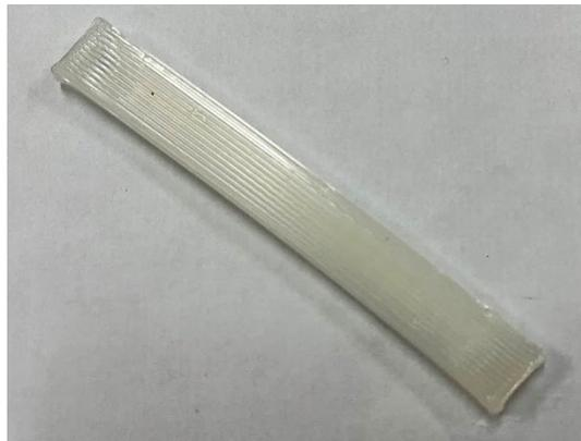
**Figura 7.15:** Esempio di un campione di Run 4, prodotto con angolo di riempimento 0°, temperatura 260°C e velocità 90 mm/s.
