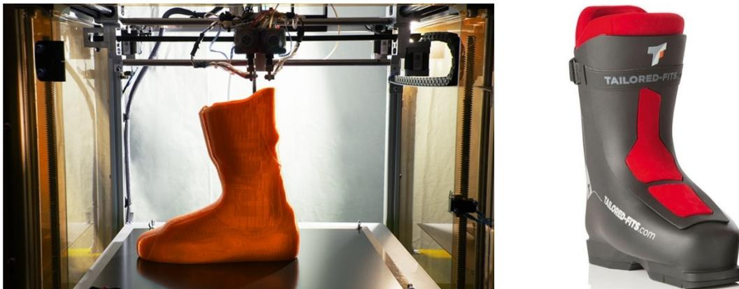
**Figura 1.10:** *Componente stampato 3D e scarpone da sci con soletta stampata 3D [43]*
