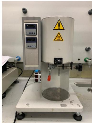
*Figura 5.11: Plastometro per la misura del Melt Flow Index*
