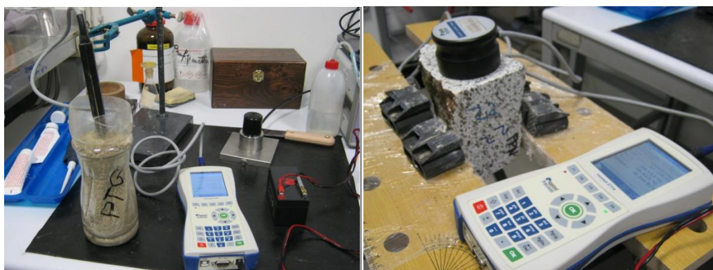
Fig.5.1.1.2: Esempi di misure con lo strumento ISOMET 2114
