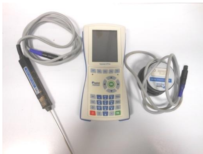
Fig.5.1.1.1: In figura lo strumento ISOMET 2114 e i due tipi di sonde utilizzabili
