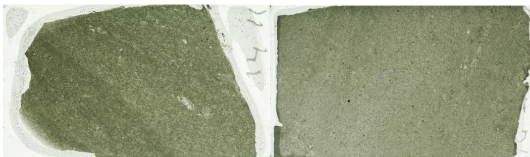
Fig.7.15a, b: Struttura macroscopica del campione. (a) superficie parallela alla foliazione, (b) sezione ortogonale alla superficie di foliazione.
