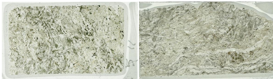
Fig.7.6a, b: Struttura macroscopica del campione. (a) Superficie parallela alla foliazione, (b) struttura scistosa da ondulata a pieghettata nella sezione ortogonale alla foliazione.
