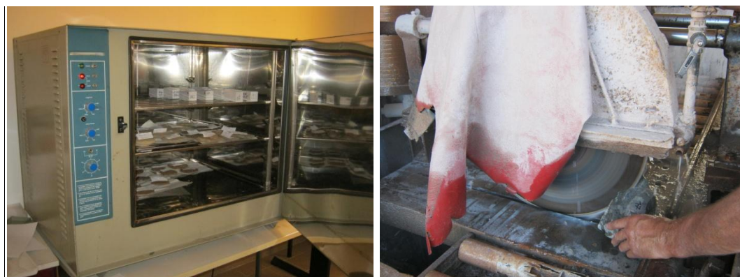
Fig.5.1.1-2: Forno utilizzato per essiccare i campioni (a sx) e fase di taglio dei campioni raccolti
