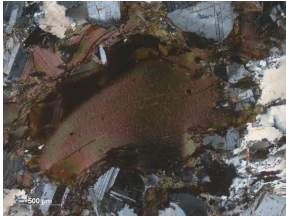
Fig.7.5: Lamella di biotite con estinzione ondulata. Luce parallela e nicol incrociati.
