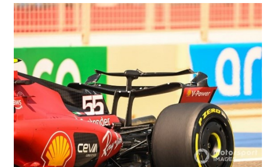
Immagine del pilone di sostegno dell'ala posteriore e il sistema DRS di riduzione di carico funzionante
