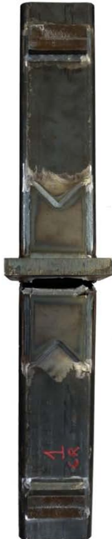
Vista complessiva a rottura
