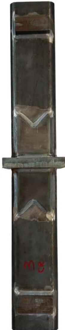
Vista complessiva a rottura
