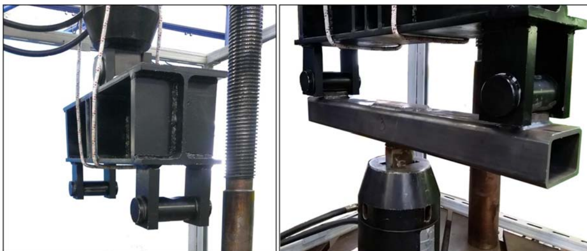
Figura 2.5 Traversa utilizzata per creare le condizioni di vincolo sul giunto, quest'ultima è afferrata dalla ganascia superiore che rimane fissa nelle prove a fatica (sinistra). Foto dello provino afferrato dalla ganascia inferiore che realizza la prova a fatica (destra).
