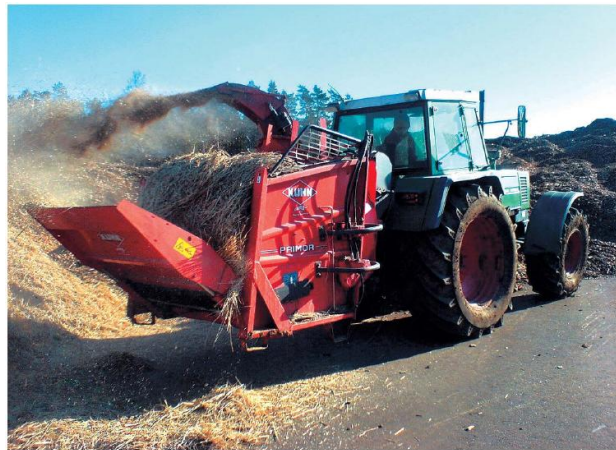
Figura 50 – Trinciatura di canne palustri mediante una trincia per rotoballe usata normalmente in ambito agricolo (Komulainen et al., 2008)
