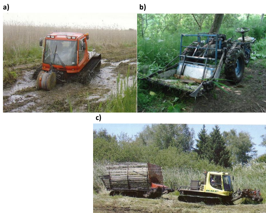
Figure 49 – Macchinari speciali: a) Prova battipista Kassbohrer Pisten Bully zavorrato nelle Paludi di Ostiglia; c) Battipista Kassbohrer Pisten Bully attrezzato con rimorchio raccogliitore cingolato e andanatrice dalla ditta NUP (Svizzera) (Cuizzi, 2005); b) Falciatrice BCS modificata, utilizzata in una piccola zona delle Valli del Mincio
