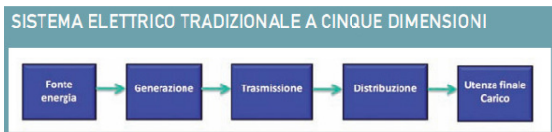
Fig19 sistema elettrico tradizionale (fonte[7])
