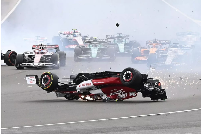
Foto 5: Zhou nel momento in cui si ribalta e prosegue sottosopra. L'Halo impedisce che la testa arrivi al terreno 39
